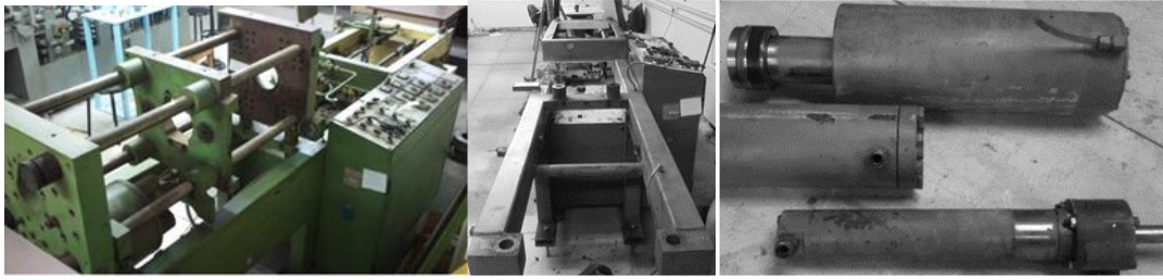
Εικόνα 10. Το αρχικό πλαίσιο της παρωχημένης μηχανής έγχυσης πλαστικού FROMAG και οι υδραυλικοί επενεργήτες που ανακτήθηκαν (δεξιά)
