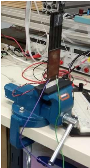
Σχήμα 3-5. Πάκτωση συναρμολογήματος με τη βοήθεια μέγγενης. Τα επιθέματα είναι τοποθετημένα κοντά στην πάκτωση όπου οι παραμορφώσεις είναι οι μέγιστες.
