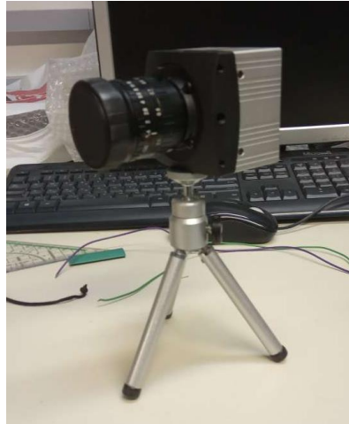
Σχήμα 3-13. Κάμερα υψηλής ταχύτητας. Χρησιμοποιείται για την καταγραφή της απόκρισης του ελεύθερου άκρου του συναρμολογήματος.
