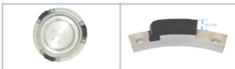
Εικόνα 3-3 Κεφαλή με κομμάτια ελαστικού για την μέτρηση της αντιολισθητικής ικανότητας
