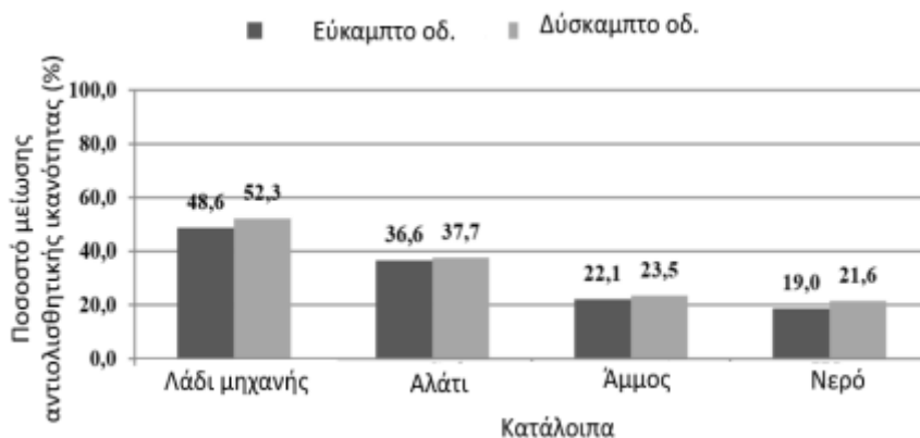
Εικόνα 2-19 Επιρροή κατάλοιπων στην αντιολισθητική ικανότητα (Lubis et al. 2018)
