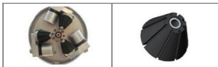
Εικόνα 3-2 Κεφαλή στίλβωσης και γεωμετρία ελαστικού κώνου
