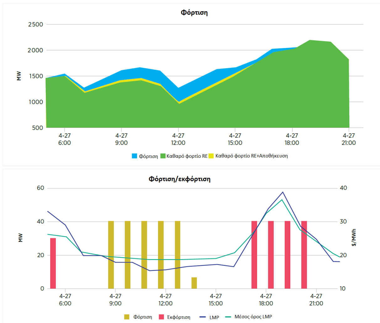
Σχ. 3-11: Παράδειγμα χρήσης μετατόπισης ανανεώσιμης ενέργειας: παραγωγή από ανανεώσιμες πηγές και καθαρό φορτίο με και χωρίς αποθήκευση ενέργειας και προφίλ φόρτισης και εκφόρτισης της αποθήκευσης ενέργειας
