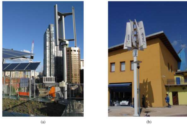
Σχήμα 2.54(a) Ανεμογεννήτρια κάθετου άξονα σε οροφή κτιρίου στην Αυστραλία, (b) Ανεμογεννήτρια κάθετου άξονα σε οροφή κτιρίου στην Σαραγόσα, Ισπανία. <<Πηγή Pacheco et al, 2013>>
