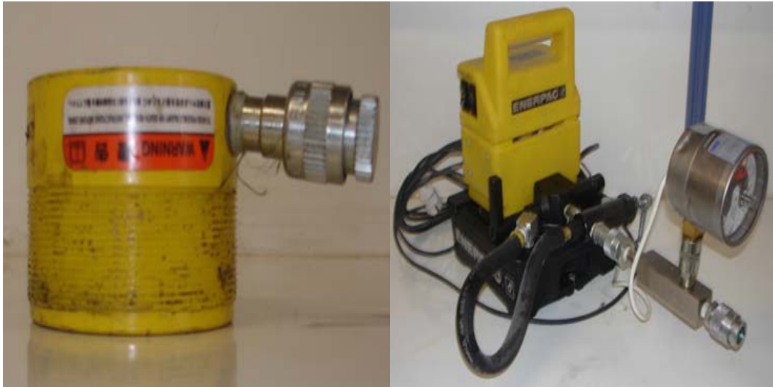
ΕΙΚΟΝΑ 3.2 Σύστημα επιβολής αξονικού φορτίου (α) υδραυλικός γρύλος και (β) ηλεκτροκίνητη αντλία λαδιού.
