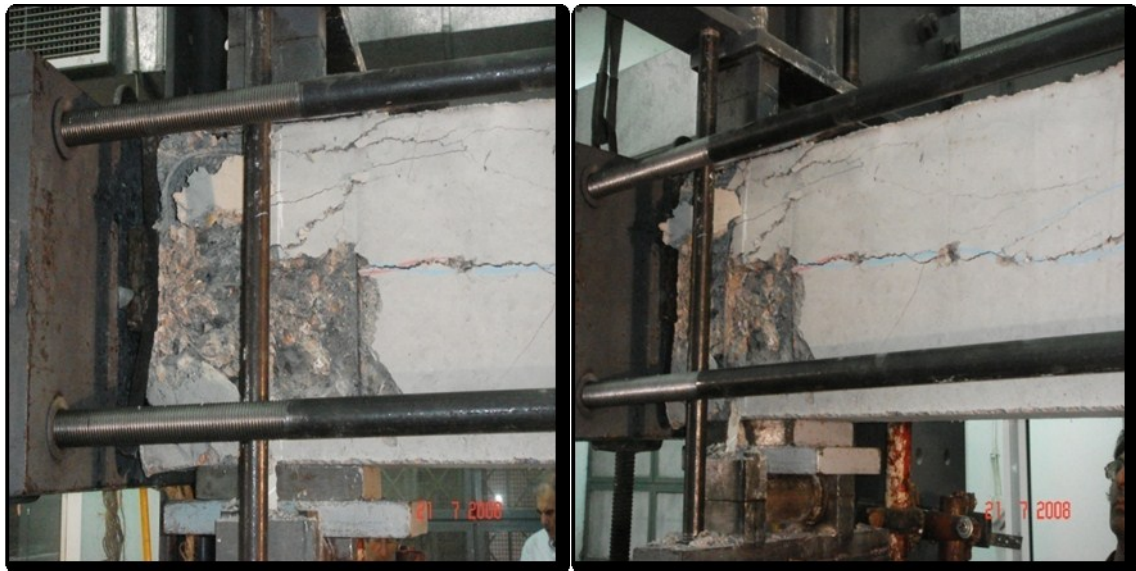
ΕΙΚΟΝΑ 4.4 Αστοχία δοκιμίου υπό Ανακυκλιζόμενη φόρτιση με αξονικό φορτίο N=750\text{KN} .
