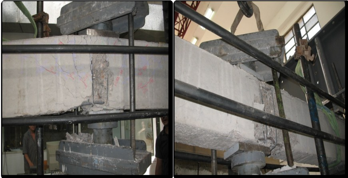
ΕΙΚΟΝΑ 4.10 Ρηγματωμένη κατάσταση του φορέα μετά την διαρροή.
