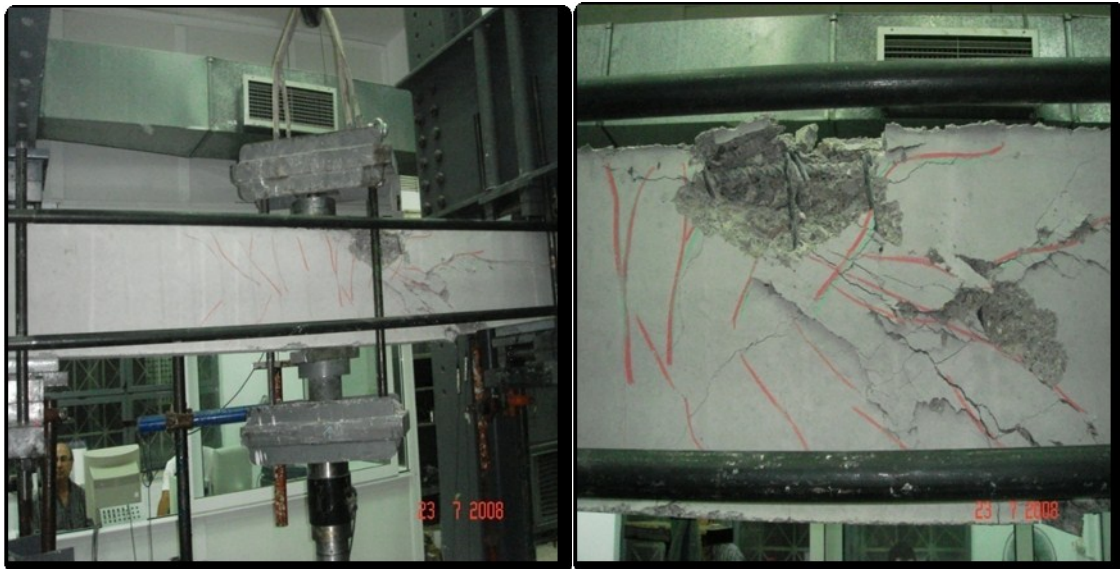
ΕΙΚΟΝΑ 4.8 Αστοχία δοκιμίου με αξονική δύναμη N=630KN, αποτίναξη σκυροδέματος.
