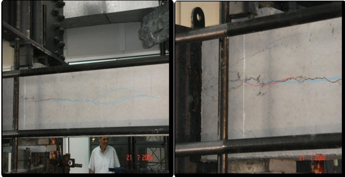
ΕΙΚΟΝΑ 4.3 Ανακυκλιζόμενη φόρτιση με αξονικό φορτίο N=750\text{KN} .
