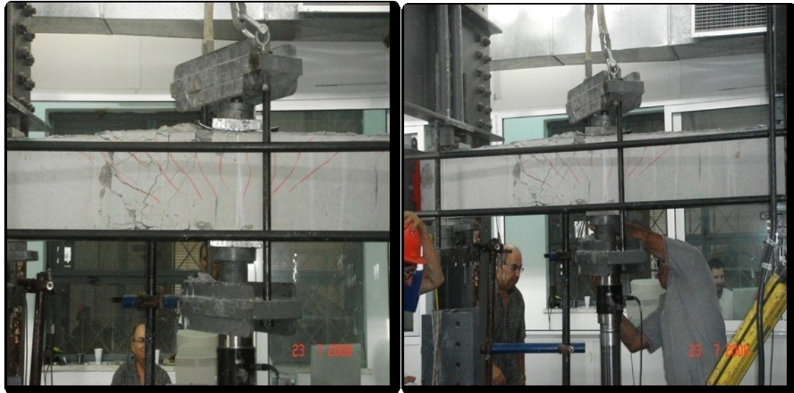
ΕΙΚΟΝΑ 4.6 Ρηγματωμένη κατάσταση του φορέα μετά την διαρροή ,N=630kN.
