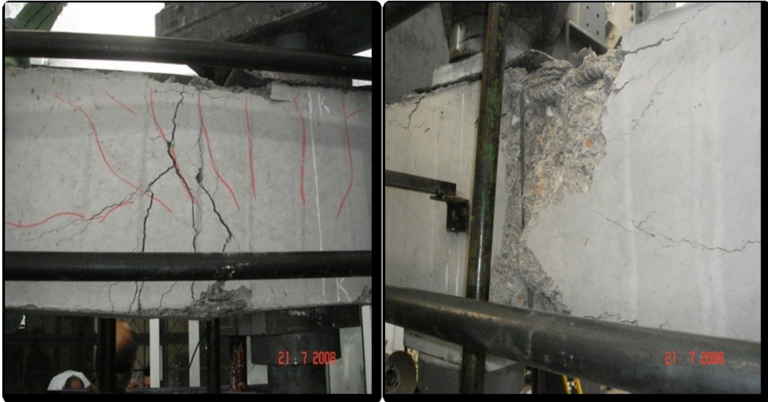
ΕΙΚΟΝΑ 4.2 Αστοχία δοκιμίου υπό Μονότονη φόρτιση με αξονικό φορτίο N=750\text{KN}
