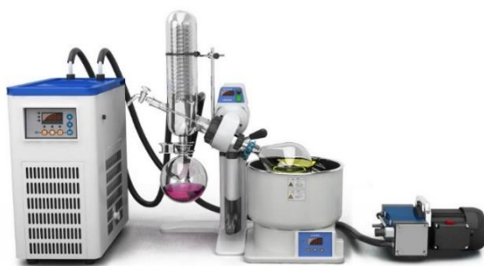
Εικόνα 39. Τυπική διάταξη περιστροφικού εξατμιστήρα συνδεδεμένη με αντλία πίεσης/κενού
