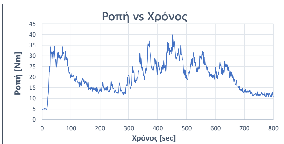
Σχήμα 21. Διακύμανση της Ροπής [Nm] της διεργασίας παραγωγής του masterbatch στον δικόχλιο εκβολέα σε 200 °C και 50 rpm συναρτήσεσι του Χρόνου [sec]
