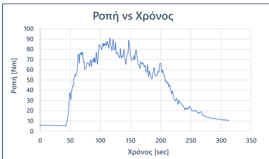
Σχήμα 19. Διακύμανση της Ροπής [Nm] της δοκιμαστικής διεργασίας εκβολής του PCR PP στον δικόχλιο εκβολέα σε 200 °C και 50 grm συναρτήσεσι του Χρόνου [sec]
