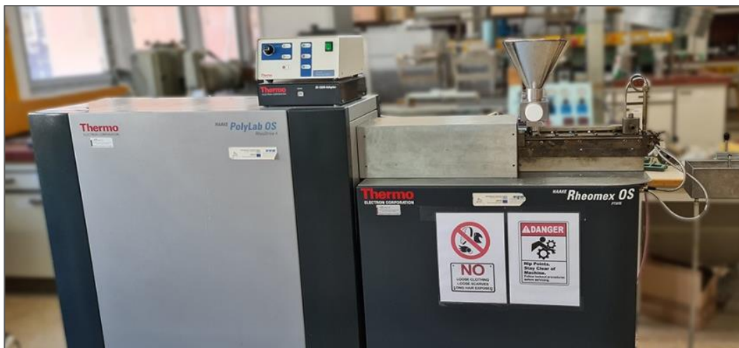
Εικόνα 33. Δικόχλιος εκβολέας του Εργαστηρίου Τεχνολογίας Πολυμερών
