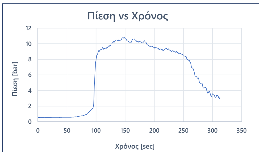
Σχήμα 20. Διακύμανση της Πίεσης [bar] της δοκιμαστικής διεργασίας εκβολής του PCR PP στον δικόχλιο εκβολέα σε 200 °C και 50 grm συναρτήσεσι του Χρόνου [sec]
