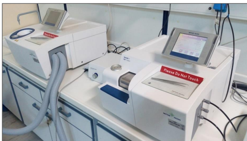
Εικόνα 31. Όργανα DSC (αριστερά) και TGA (δεξιά) του Εργαστηρίου Τεχνολογίας Πολυμερών
