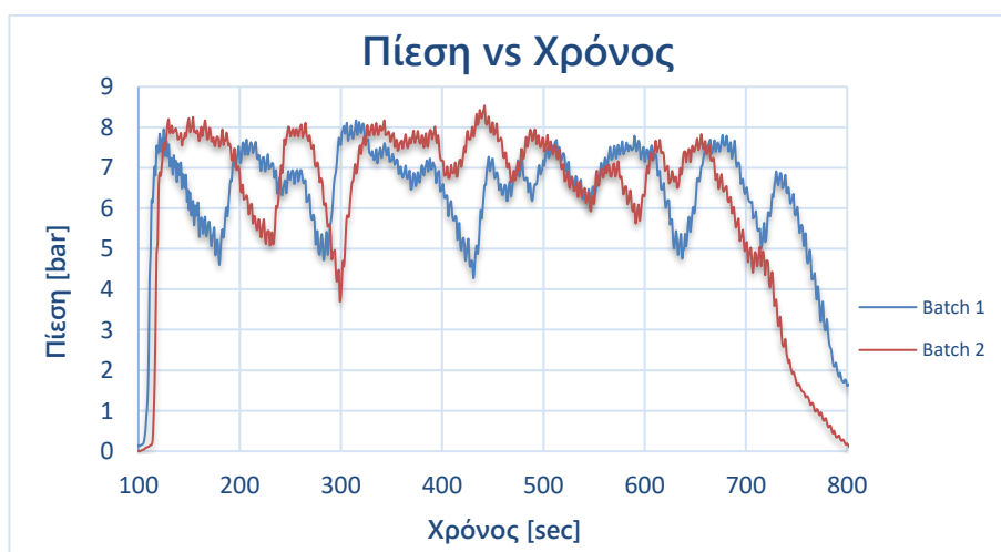
Σχήμα 24. Διακύμανση της Πίεσης [bar] της διεργασίας παραγωγής του compound συναρτήσει του Χρόνου [sec]
