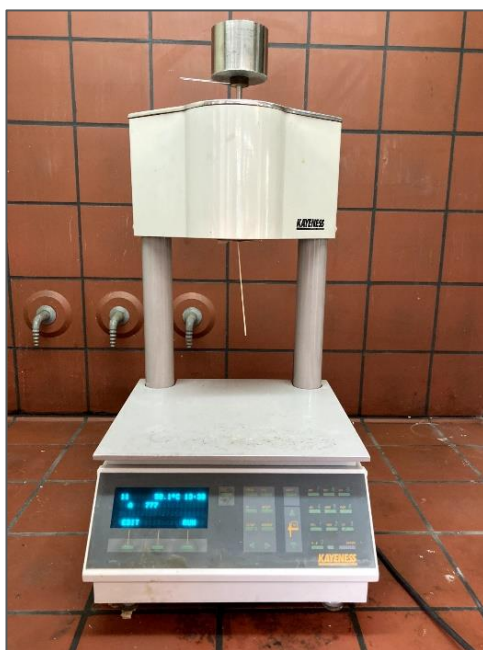
Εικόνα 27. Συσκευή μέτρησης ρυθμού ροής τήγματος του Εργαστηρίου Τεχνολογίας Πολυμερών
