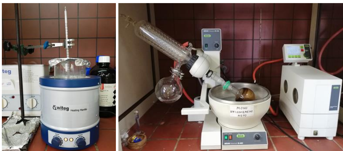
Εικόνα 26. Συμβατική εκχύλιση σε θερμαντικό μανδύα (αριστερά) και εξάτμιση σε περιστροφικό εξατμιστήρα (δεξιά)
