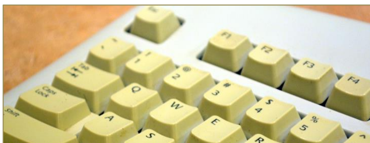
Εικόνα 14. Χαρακτηριστικό κιτρίνισμα υλικού πλαστικού πληκτρολογίου μετά από ορισμένο χρόνο ζωής
