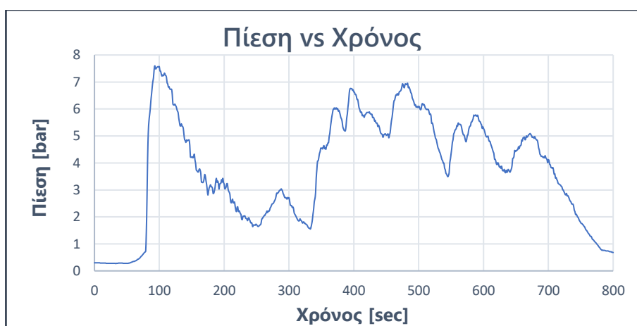
Σχήμα 22. Διακύμανση της Πίεσης [bar] της διεργασίας παραγωγής του masterbatch στον δικόχλιο εκβολέα σε 200 °C και 50 rpm συναρτήσεσι του Χρόνου [sec]
