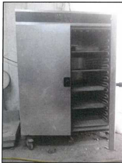
Εικόνα 5.6 Εργαστηριακός φούρνος για την ξήρανση των α' υλών.
