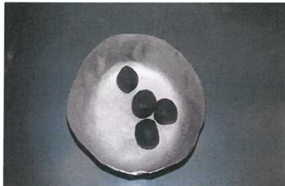
Εικόνα 5.9 Εργαστηριακό κλίνκερ για τσιμέντο τύπου G-HSR.
