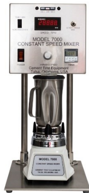
Εικόνα 5.15 Πρότυπη συσκευή ανάδευσης
