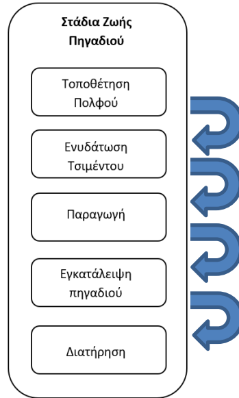
Εικόνα 1.8 Στάδια τσιμεντώσης ενός πηγαδιού
