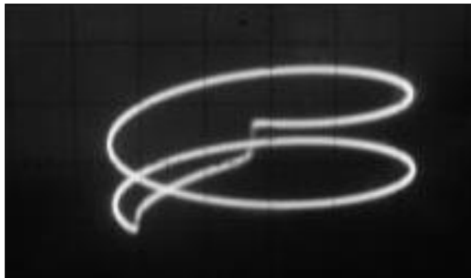
Σχήμα 6.26 Τάση εισόδου V_{rms}=1.88 V-συχνότητα εισόδου 100 kHz-διπλασιασμός περιόδου.
