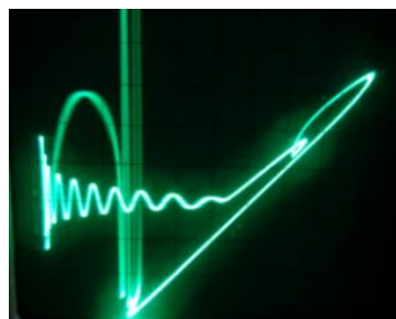
Σχήμα 8.3 Απόκριση οδηγού LED, περίοδος-1, 50 kHz, γράφημα χώρου φάσεων (δίοδος 1N4007) [88].
