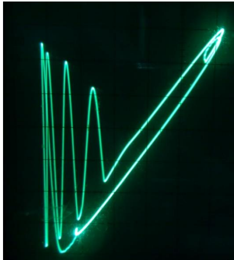
Σχήμα 8.11 Απόκριση οδηγού LED, περίοδος-1, 88 kHz, γράφημα χώρου φάσεων (δίοδος 1N4148).
