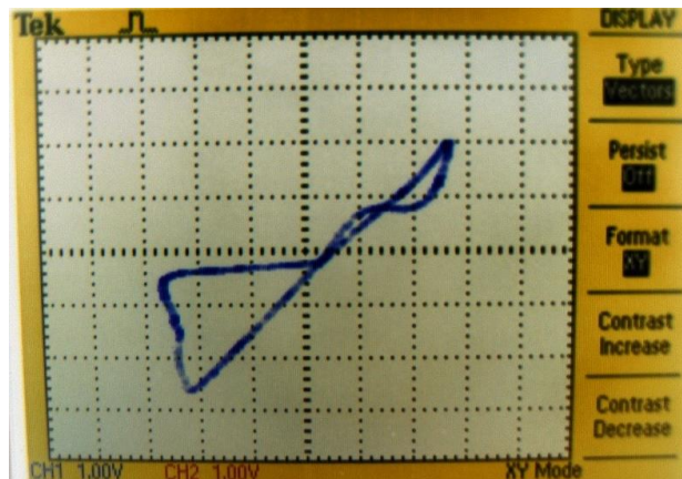
Σχήμα 6.17 Απεικόνιση X-Y- τάσης εισόδου-τάσης εξόδου με συχνότητα εισόδου 100 kHz.
