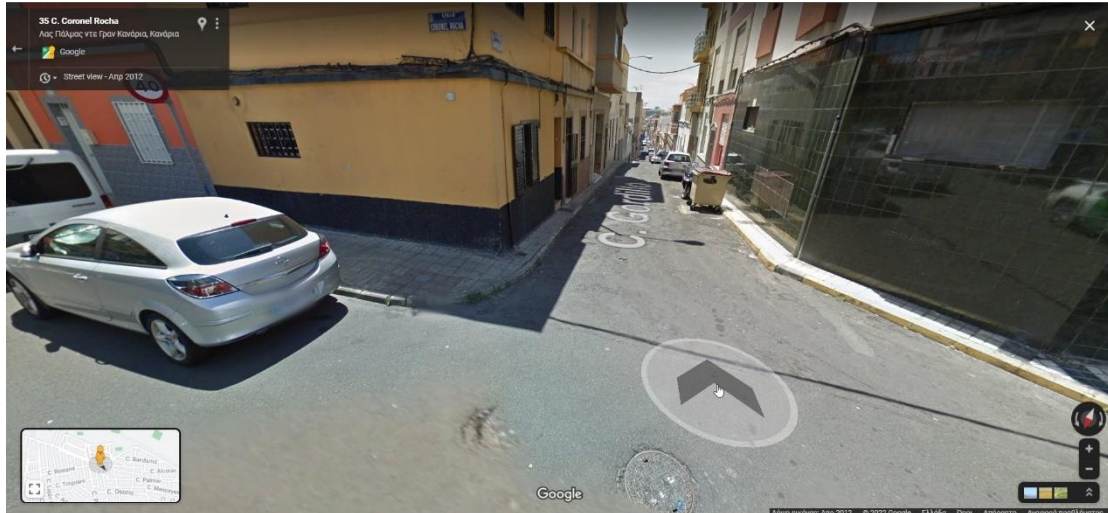
Εικόνα 3.52: Παράδειγμα σύνδεσης πεζοδρομίων χωρίς ράμπες ή κακής κατάστασης όπου η C1_4=0 στην πόλη Λας Πάλμας (Πηγή: Google Street View)
