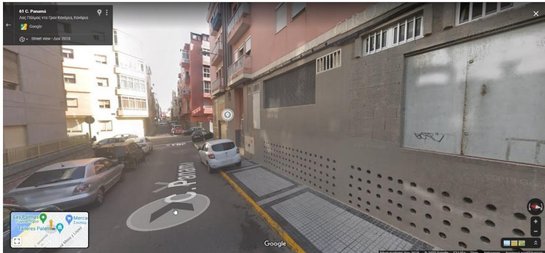
Εικόνα 3.39: Παράδειγμα τμήματος με παρκαρισμένο όχημα πάνω σε πεζοδρόμιο όπου η S15=0 , στην πόλη Λας Πάλμας (Πηγή: Google Street View)
