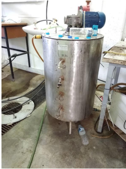
Εικόνα 4-4: Συμβατικό σύστημα αναερόβιας χώνευσης, τύπου CSTR
