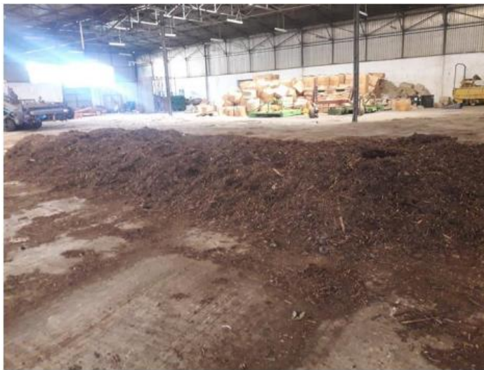
Εικόνα 4-21: Κομποστοποίηση ημι-βιομηχανικής κλίμακας σε σειράδι
