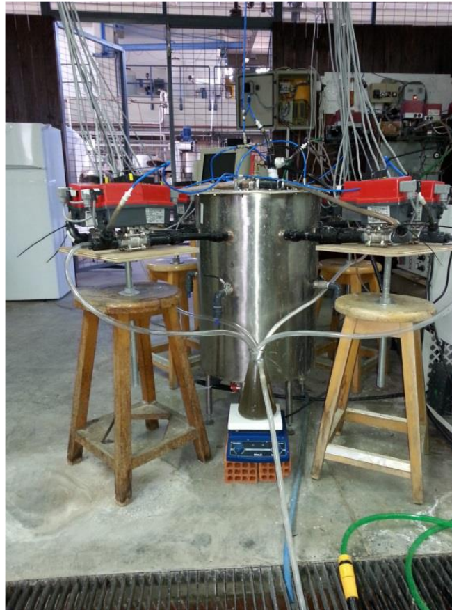
Εικόνα 4-8: Αντιδραστήρας PABR πιλοτικής κλίμακας, Σχολή Χημικών Μηχανικών, ΕΜΠ
