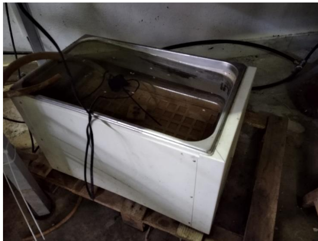
Εικόνα 4-5: Λουτρό παροχής θερμού νερού για τη διατήρηση μεσόφιλων συνθηκών
