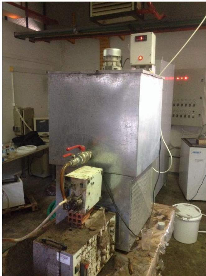
Εικόνα 4-9: Ταχύρρυθμο σύστημα αναερόβιας χώνευσης PABR, ψυγείο αποθήκευσης τροφοδοσίας και περισταλτική αντλία
