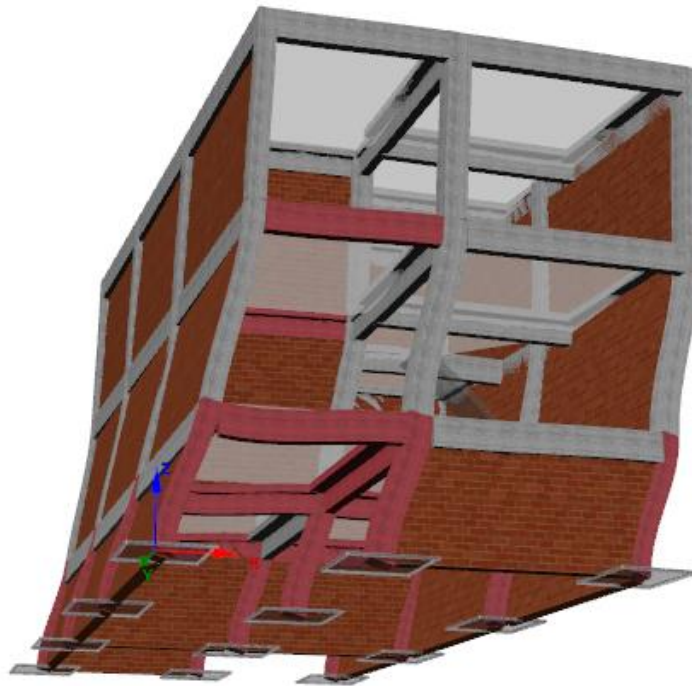
Σχήμα 3.10: Απεικόνιση κατασκευής για έλεγχο Τέμνουσας-Μέγιστη Τέμνουσα Βάσης
