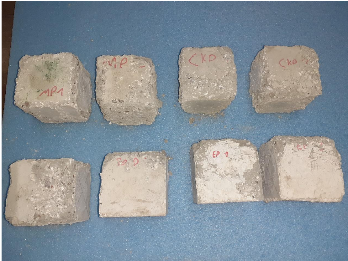
Εικόνα 25 Εκρηκτική αποφλοίωση δοκιμίων ΑΣΣ κατόπιν θερμικής καταπόνησης στους 8000C.
