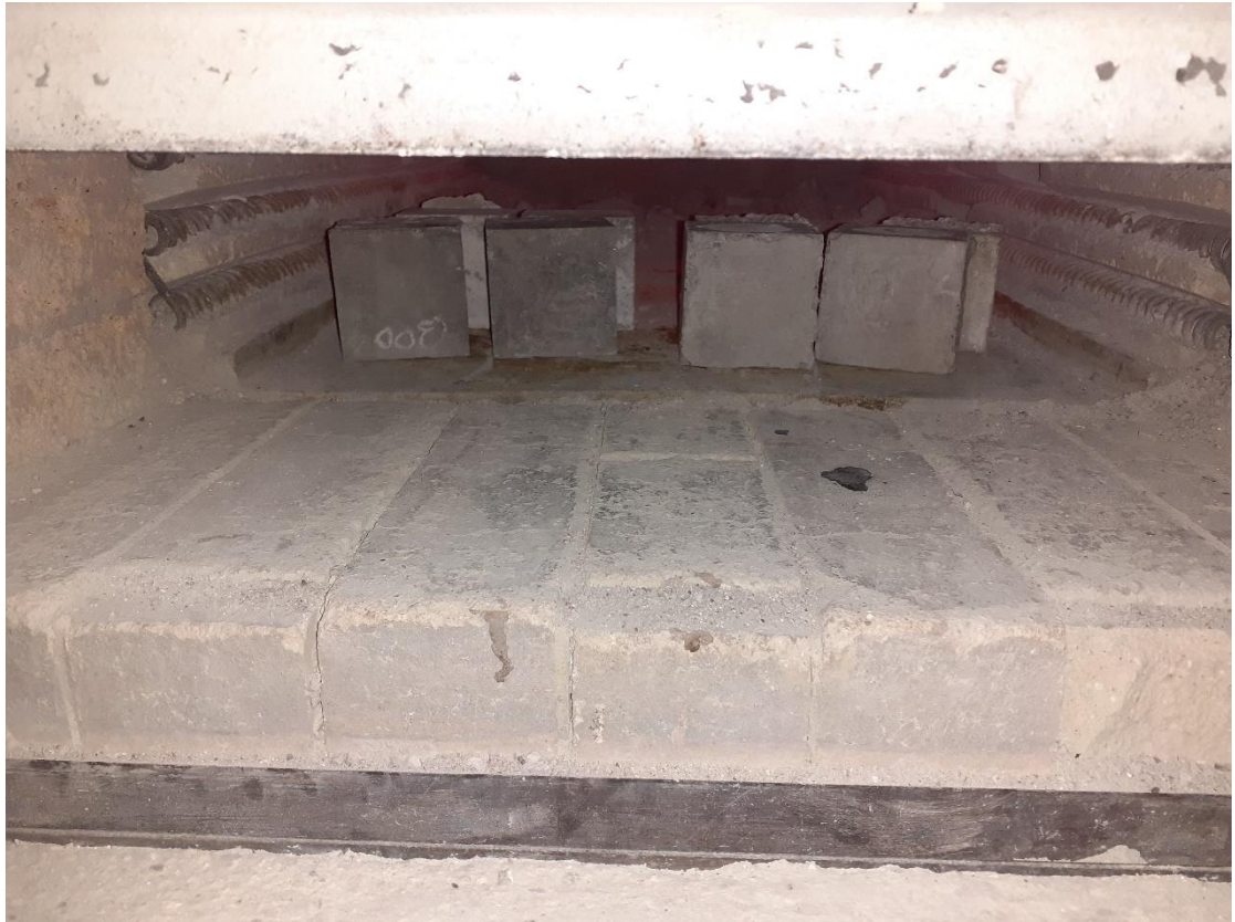
Εικόνα 23 Εισαγωγή κυβικών δοκιμίων ΑΣΣ σε ειδικό κλίβανο για θερμική καταπόνηση σε διαδικασίες υψηλών θερμοκρασιών.
