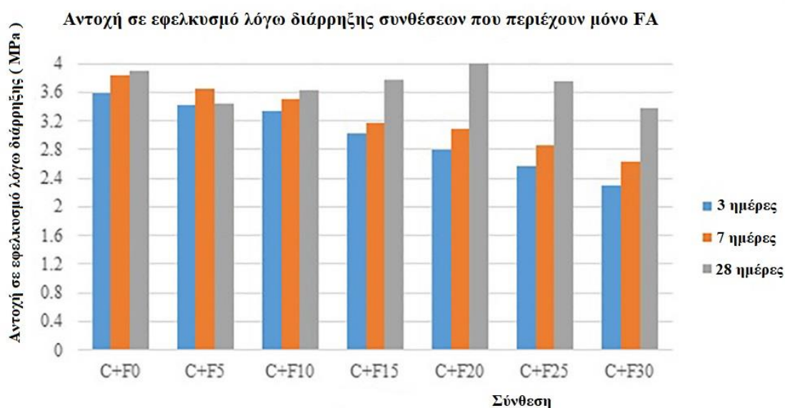
Σχήμα 1.10 Αποτελέσματα δοκιμών αντοχής σε εφελκυσμό λόγω διάρρηξης ( MPa ) των συνθέσεων που περιέχουν μόνο FA σε διάφορες ηλικίες.
