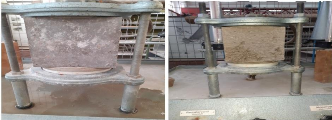
Εικόνα 20 Κυβικά δοκίμια 150X150X150 mm στη συσκευή ελέγχου Υδατοπερατότητας.
