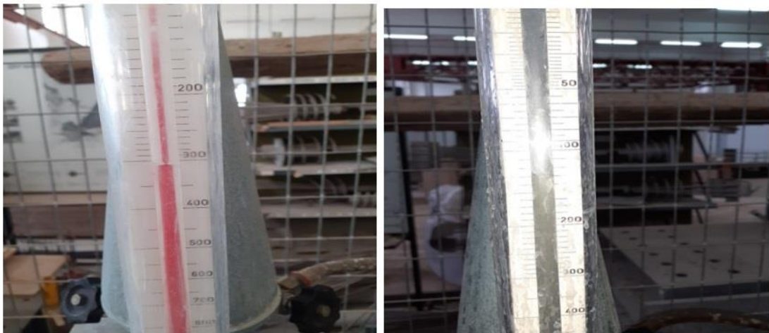
Εικόνα 21 Μανομετρικές ενδείξεις κατά τη δοκιμή ελέγχου Υδατοπερατότητας.
