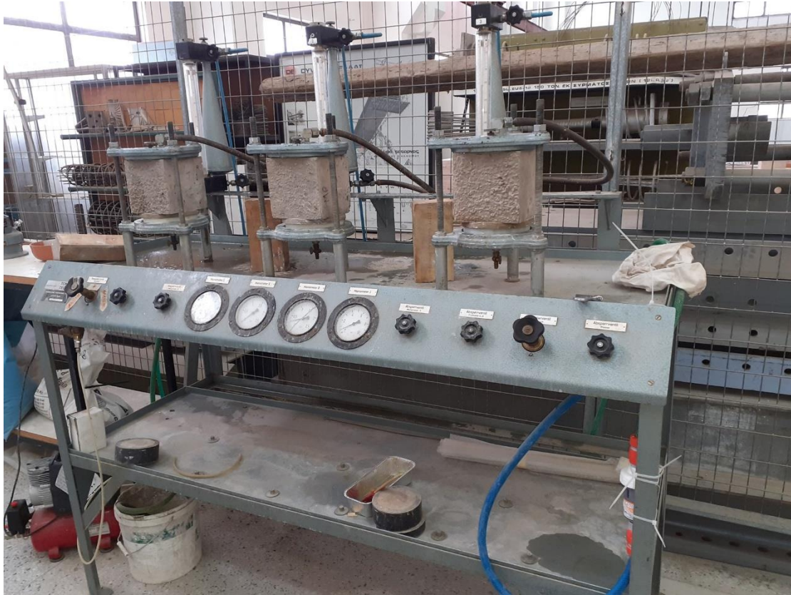
Εικόνα 22 Πειραματική διάταξη για τον προσδιορισμό της αντοχής κυβικών δοκιμίων ΑΣΣ σε Υδατοπερατότητα.
