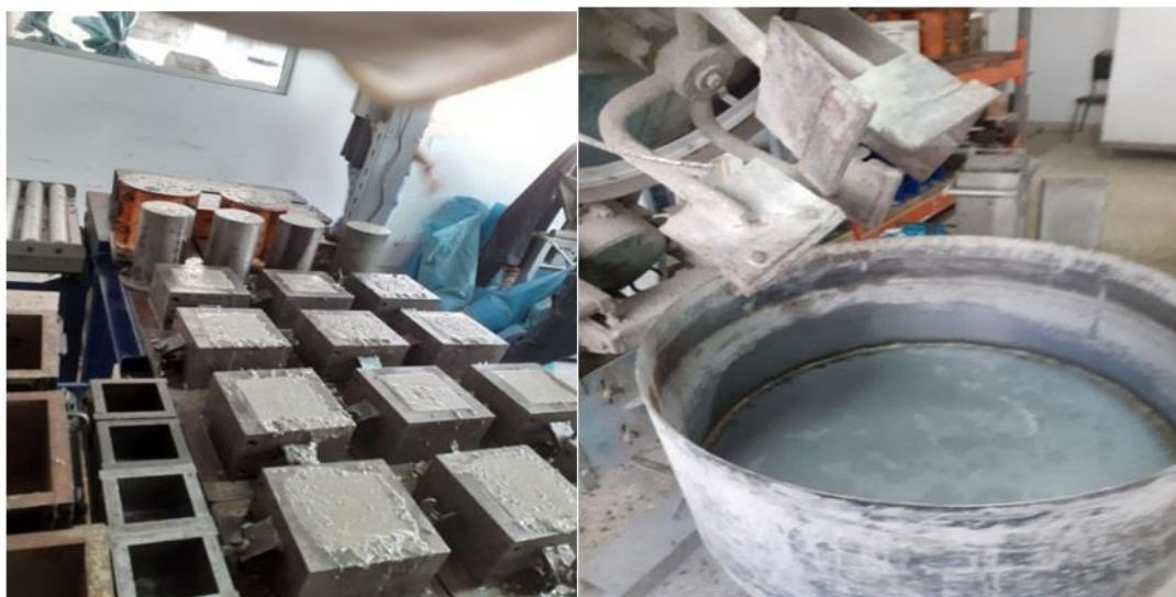
Εικόνα 10 Ανάμιξη των συστατικών του ΑΣΣ και χύτευση του νωπού ΑΣΣ σε μεταλλικές μήτρες τυποποιημένων διαστάσεων.
