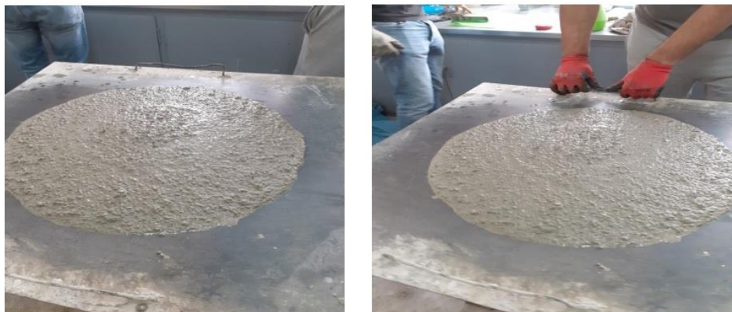
Εικόνα 9 Προσδιορισμός ρεολογικών ιδιοτήτων νωπού ΑΣΣ.
