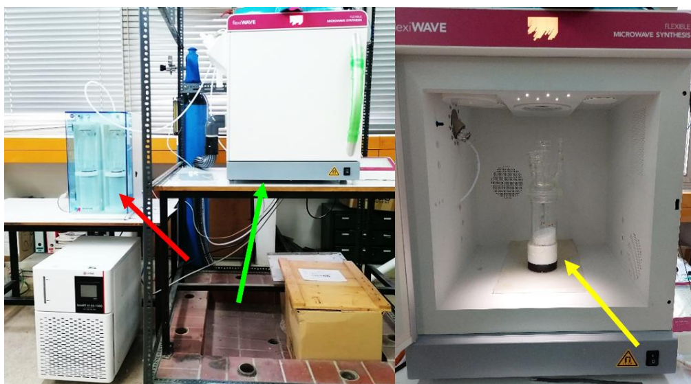
Εικόνα 24: Εξοπλισμός της σύνθεσης πολυουρεθανών με την χρήση μικροκυμάτων. Κόκκινο βέλος: αντλία κενού, Πράσινο βέλος: φούρνος μικροκυμάτων Milestone, Κίτρινο βέλος: Αντιδραστήρας τοποθετημένος εντός του φούρνου.
