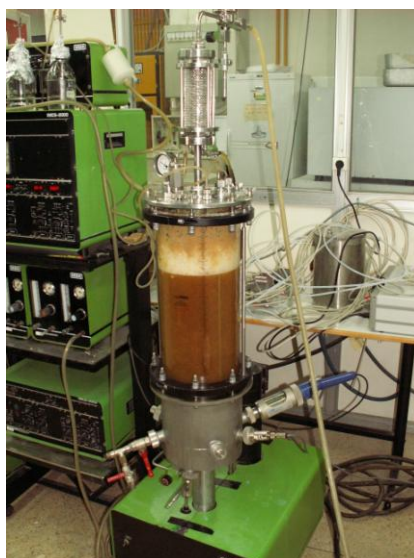
Εικόνα 4.2 Ανάπτυξη του G. australe ATHUM 4345 σε βιοαντιδραστήρα βυθισμένης καλλιέργειας 20 L στο εργαστήριο
