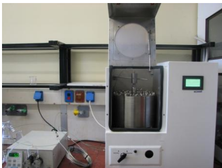
Εικόνα 2.12 Συσκευή Kromaton FCPC που χρησιμοποιήθηκε στο εργαστήριο
