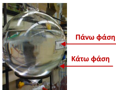
Εικόνα 7.27 Παρασκευή του επιλεγμένου συστήματος διαλυτών (6) για το χρωματογραφικό διαχωρισμό με FCPC του κλάσματος LPXDM. Διακρίνονται οι δύο φάσεις, που χρησιμοποιήθηκαν στο σύστημα FCPC
