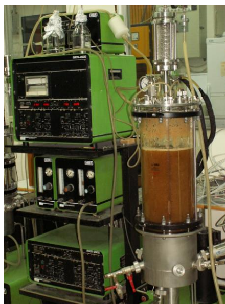
Εικόνα 5.1. Ανάπτυξη του P. ostreatus ATHUM 4438 σε βιοαντιδραστήρα 20L
