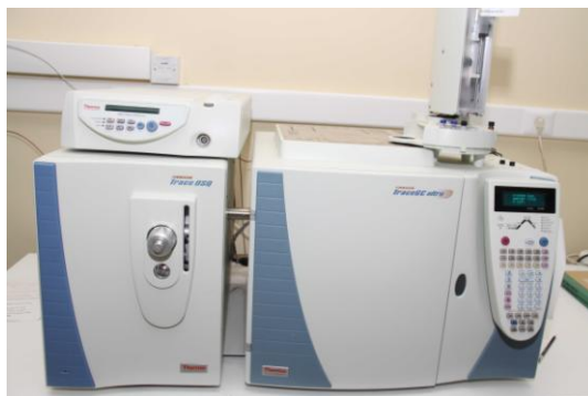
Εικόνα 2.13. Αέριος Χρωματογράφος συζευγμένος με Φασματογράφο Μάζας (GC-MS) που χρησιμοποιήθηκε στο εργαστήριο
