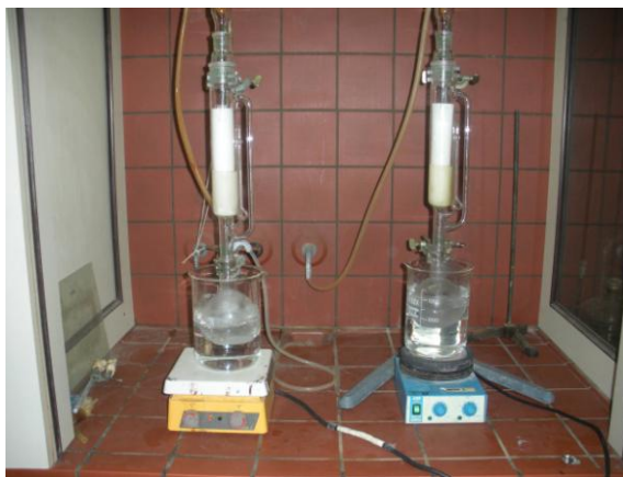
Εικόνα 2.4 Η διάταξη Soxhlet στην οποία έλαβαν χώρα ταυτόχρονα δύο εκχυλίσεις
