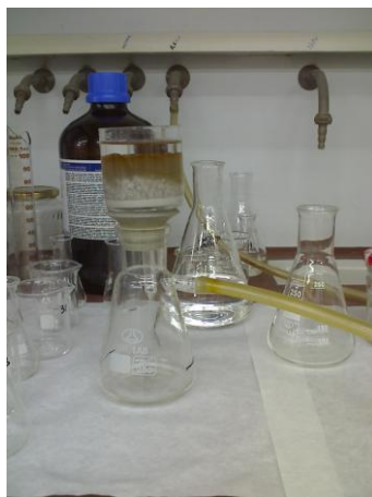
Εικόνα 2.8 Υγρή χρωματογραφία στήλης ανοιχτού τύπου υπό κενό (VLC) που χρησιμοποιήθηκε στο εργαστήριο
