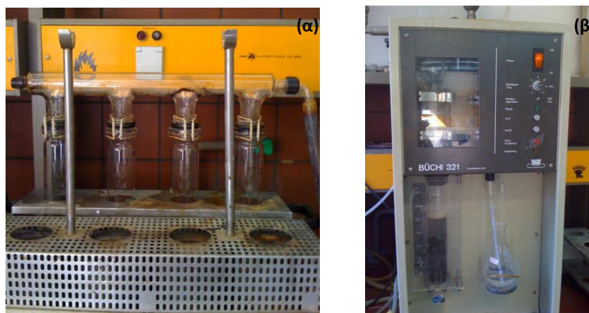
Εικόνα 2.3 Συσκευές (α) καύσης και (β) απόσταξης που χρησιμοποιήθηκαν για τον προσδιορισμό του οργανικώς δεσμευμένου αζώτου (N%) κατά Kjeldahl στις αναλύσεις
