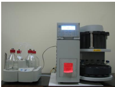
Εικόνα 2.6 Συσκευή εκχύλισης ASE 300 που χρησιμοποιήθηκε στο εργαστήριο
