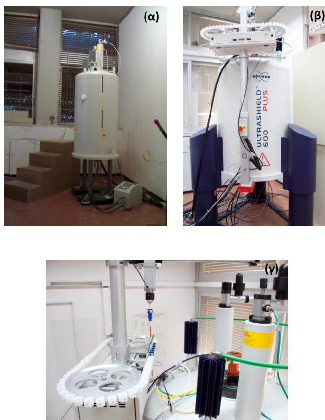
Εικόνα 2.14 Φασματογράφοι NMR (α) Bruker DRX 400 (400 MHz) και (β), (γ) Bruker Avance III 600 (600 MHz) στους οποίους πραγματοποιήθηκε η λήψη των φασμάτων
