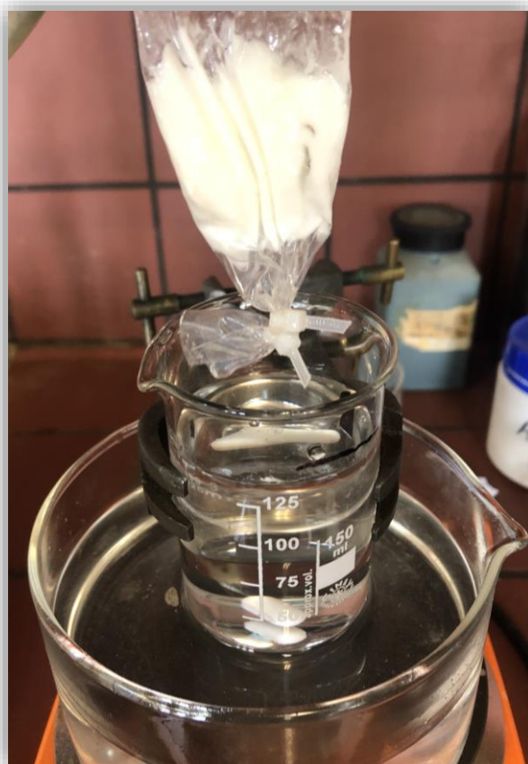
Εικόνα 8: Πειραματική διάταξη για την εφαρμογή της μεθόδου μεμβρανών διάλυσης-διάχυσης.
