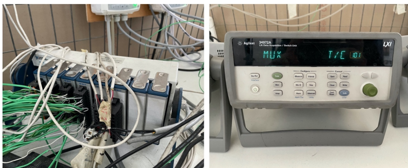
Σχήμα 4.28: Συστήματα συλλογής δεδομένων NI cDAQ-9172 (αριστερά) και Agilent 34972A (δεξιά).
