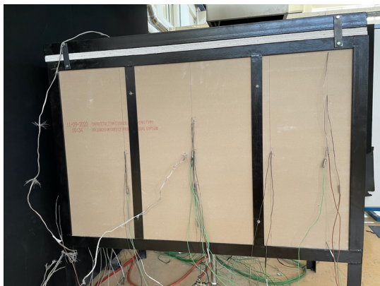
Σχήμα 4.21: Εσωτερικά θερμοστοιχεία πλαϊνού τοιχώματος.
