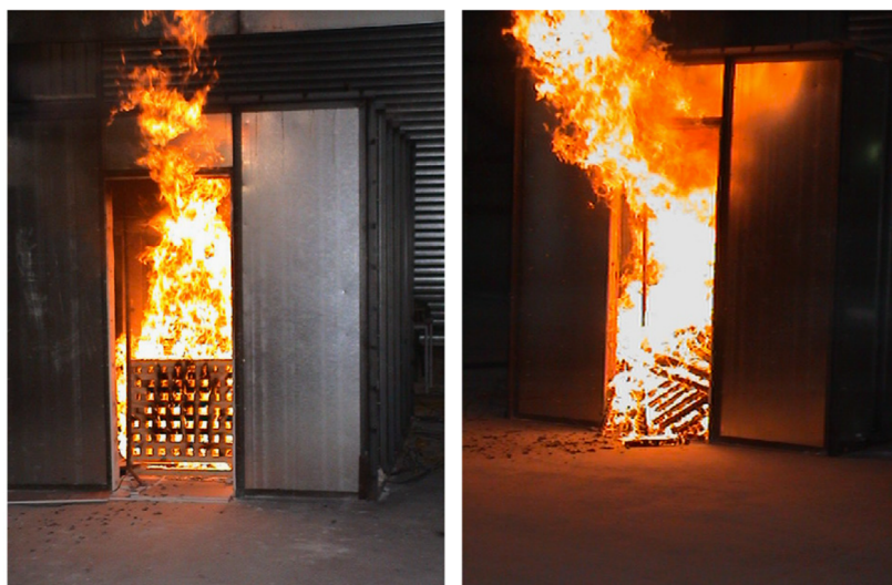
Σχήμα 3.1: Απεικόνιση κατάρρευσης στοίβας ξύλινων δοκιμών (Moinuddin et al., 2011).
