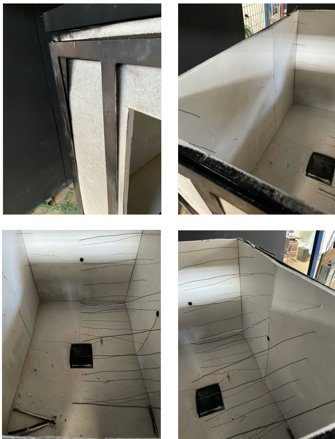
Σχήμα 5.28: Εικόνες του διαμερίσματος μετά το πέρας των δοκιμών Q – SICA.
