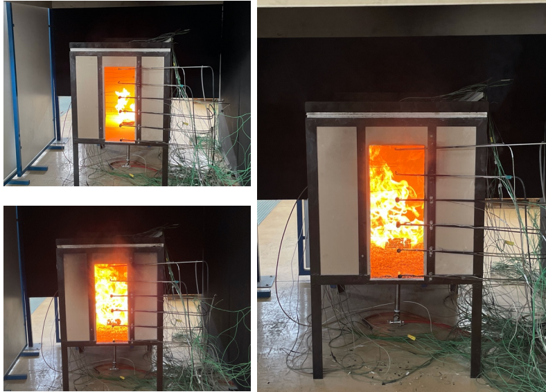
Σχήμα 5.29: Στιγμιότυπα από το πείραμα ISO – GP στο 1 ο λεπτό (πάνω αριστερά), στα 30 λεπτά (δεξιά) και στην 1 ώρα (κάτω αριστερά).
