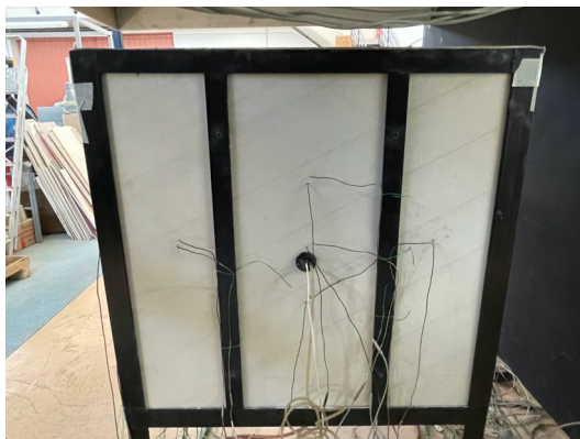
Σχήμα 4.23: Εσωτερικά θερμοστοιχεία οπίσθιου τοιχώματος.
