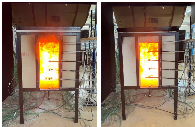
Σχήμα 5.20: Στιγμιότυπα φωτιάς σε διαμέρισμα μπροστινής όψης για τα πειράματα Q68 - GP2 (αριστερά) και Q68 - SICA (δεξιά).
