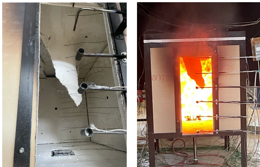
Σχήμα 5.27: Εικόνα κατά τη διάρκεια της δοκιμής Q102 – GP2 (δεξιά) και μετά το πέρας (αριστερά).
