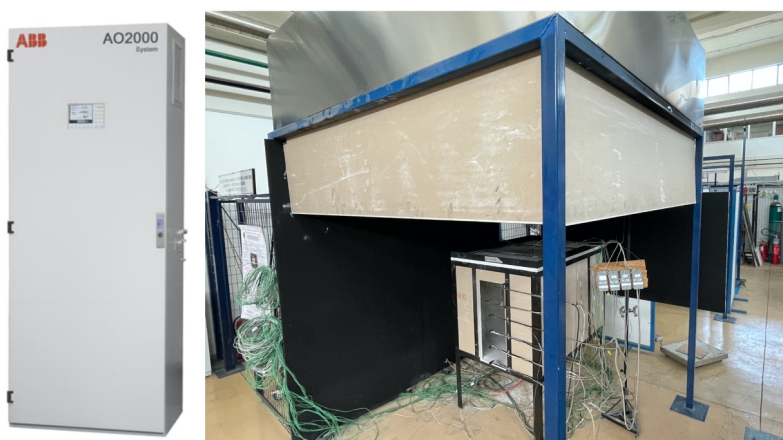
Σχήμα 4.9: Αναλυτής καυσαερίων (αριστερά) και αγωγός απαγωγής καυσαερίων (δεξιά)
