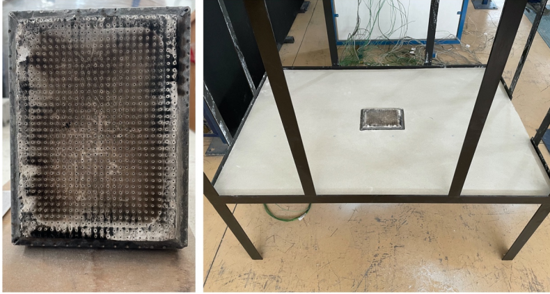
Σχήμα 4.12: Πορώδης καυστήρας (αριστερά) και η θέση του στο διαμέρισμα (δεξιά).
