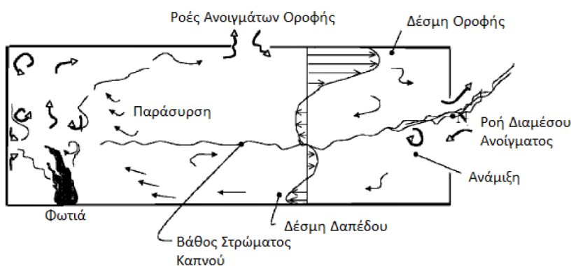
Σχήμα 2.1: Τυπικό ροϊκό πεδίο φωτιάς σε πυροδιαμέρισμα
