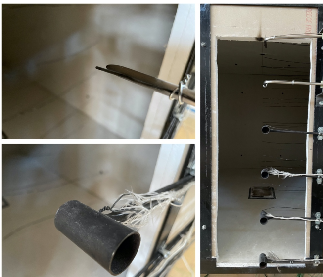
Σχήμα 4.16: Τοποθέτηση θερμοστοιχείων ανοίγματος μαζί με αισθητήρες μέτρησης ταχύτητας.
