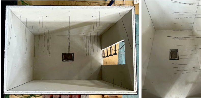
Σχήμα 4.15: Θερμοστοιχεία κεντρικής γραμμής σε κάτοψη (αριστερά) και σε εμπρόσθια όψη (δεξιά).
