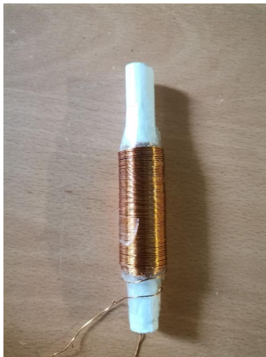
Εικόνα 4.6: Ηλεκτρομαγνητική μικρογεννήτρια με μαγνήτες 10 mm.
