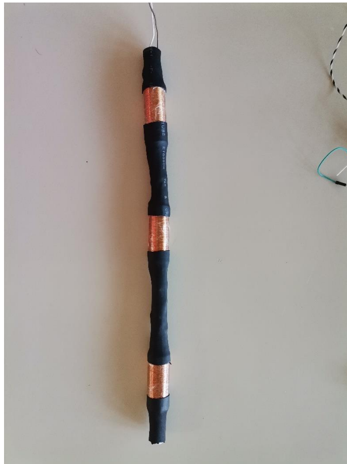
Εικόνα 4.7 Τελική γεννήτρια με 2 πηνία των 10 mm και 1 των 8 mm σε σειρά
