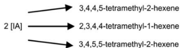
Εικόνα 21: Παράπλευρες αντιδράσεις διμερισμού ολεφινών κατά την παραγωγή TAE
