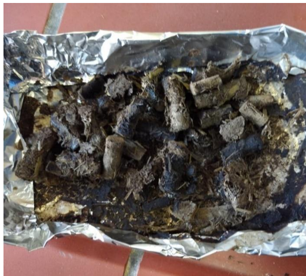
Εικόνα 20: Υπολείμματα φίλτρων οξικής κυτταρίνης μετά από αναερόβια χώνευση
