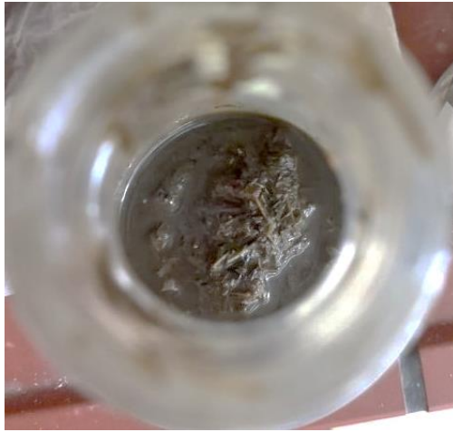
Εικόνα 19: Τελικό διάλυμα χώνευσης ολόκληρων αποτσιγάρων όπου παρατηρούνται μη διασπασμένα φίλτρα
