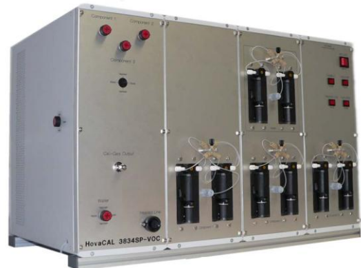
Εικόνα 5. Εμπορικά διαθέσιμη συσκευή παραγωγής αερίων μιγμάτων με σταθερό προφίλ συγκεντρώσεων (μοντέλο HovaCAL 3834SP-VOC)
