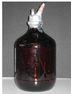
Εικόνα 25. Στατικό δοχείο αραιώσης (dilution bottle) για την παρασκευή πρότυπου αερίου
