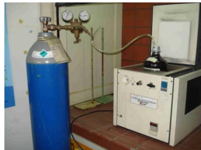
Εικόνα 25. Στατικό δοχείο αραιώσης (dilution bottle) για την παρασκευή πρότυπου αερίου
