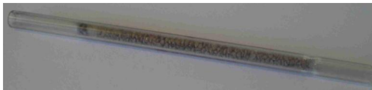
Εικόνα 15. Φύσιγγα με δομικά υλικά (τσιμέντο) για τη μελέτη της αλληλεπίδρασής τους με τις οσμές του προσομοιωτή οσμών
