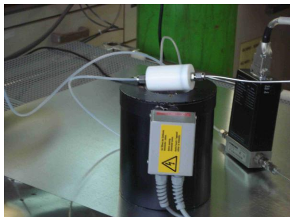
Εικόνα 24. Θάλαμος εξάτμισης εντός του θερμαινόμενου κυλίνδρου
