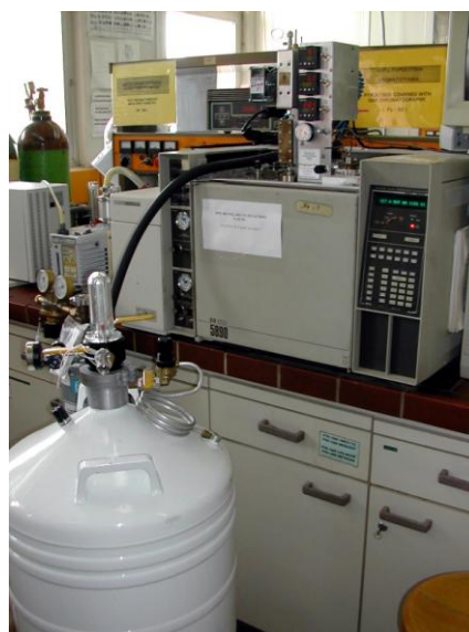
Εικόνα 12. Μονάδα θερμικής εκρόφησης συζευγμένη με αέριο χρωματογράφο και φασματόμετρο μάζας (TDU/GC/MS) όπως αναπτύχθηκε από το Εργαστήριο Ανόργανης και Αναλυτικής Χημείας
