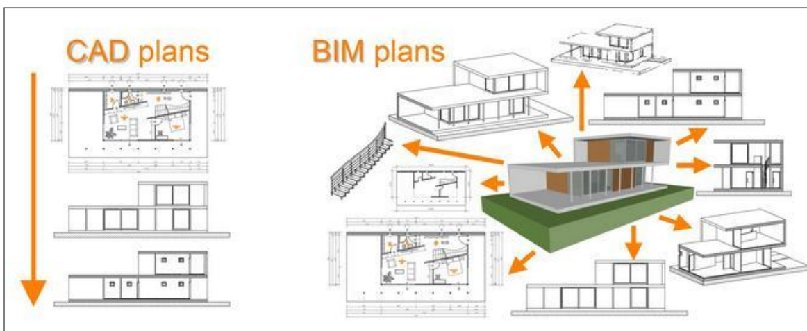
Εικόνα 9. Από τα σχέδια CAD στα σχέδια BIM (Πηγή: https://www.cadtobim.com/ )
