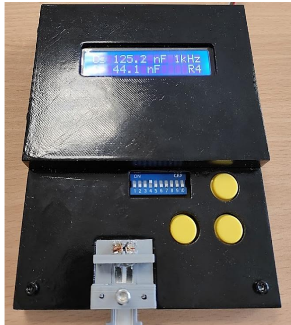
Εικόνα 72 – Επιτυχής μέτρηση χωρητικότητας
