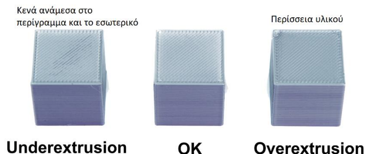
Εικόνα 13 – Παράδειγμα υπό και υπερ εξώθησης
