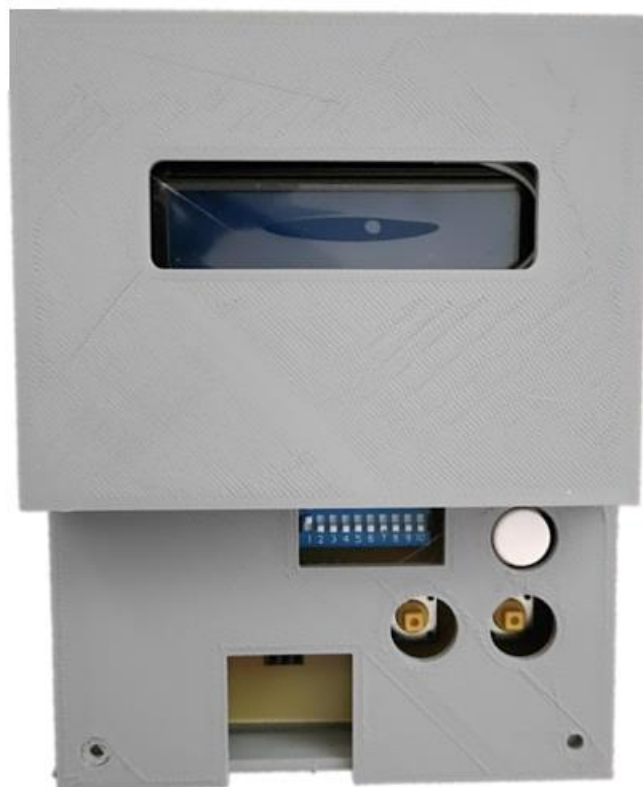
Εικόνα 69 - Συναρμολόγηση συσκευασίας πριν τη τελική επεξεργασία
