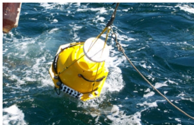
Σχήμα 1.2.5: Ένα ARU κατά την εναπόθεσή του στη Θάλασσα [18].
