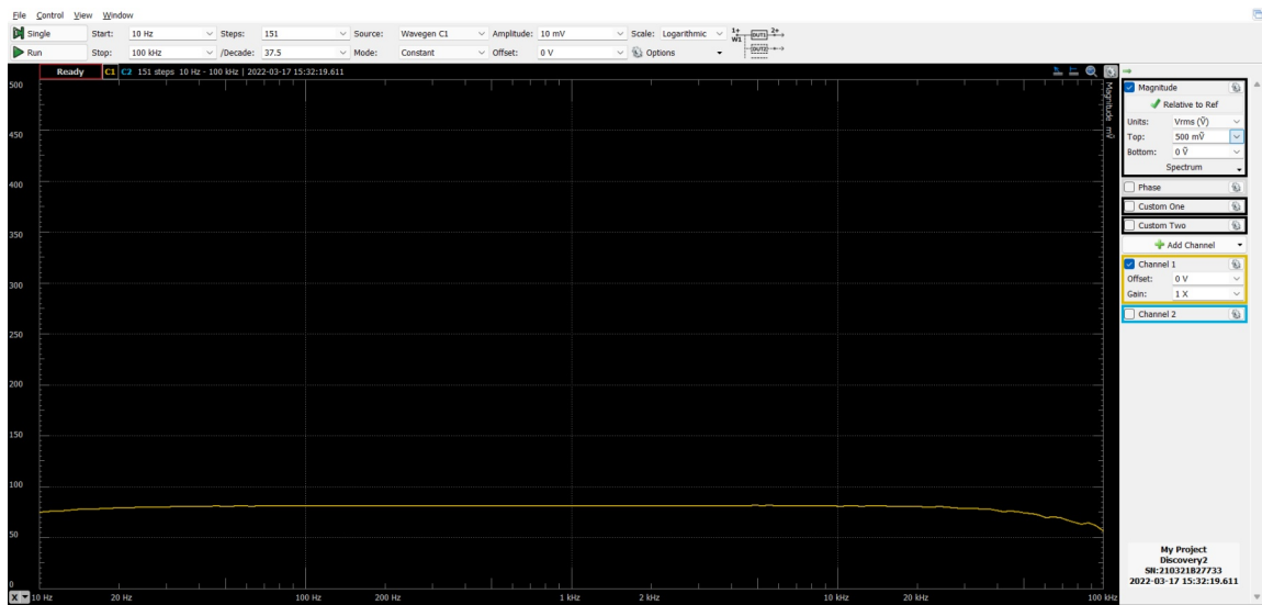
Σχήμα 6.4.3.5: Η απόκριση του κυκλώματος MC401 στο εύρος 10Hz-20kHz.
