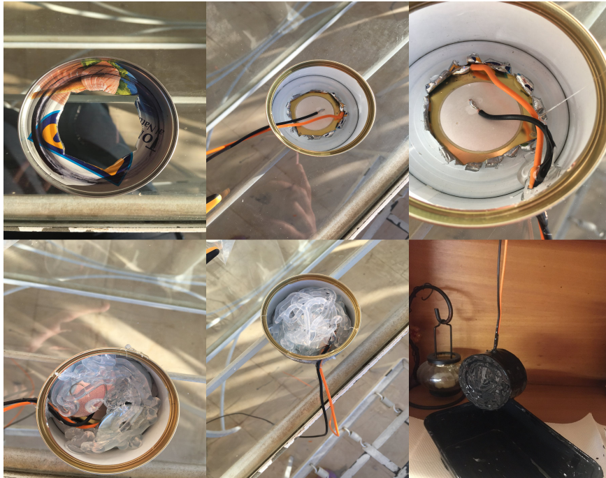
Σχήμα 6.3.1.1: Τα στάδια κατασκευής του υδροφώνου με περίβλημα μεταλλικού δοχείου: Άνοιγμα οπών, τοποθέτηση κάψας, βαριδίων και καλωδίων, σταθεροποίηση καλωδίων με χρήση κόλλας, γέμισμα του εσωτερικού με σιλικόνη, και εμφύσηση στο υγρό καουτσούκ.
