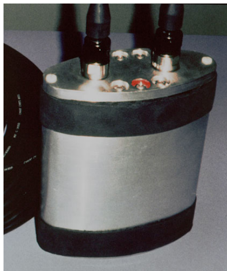
Σχήμα 4.1.4.2: Ένας μετατροπέας class IV μαγνητοσυστολικού τύπου [43].
