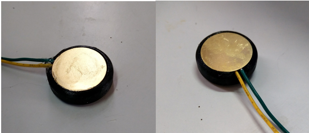
Σχήμα 6.3.2.4: Η τοποθέτηση και κόλληση της πιεζοηλεκτρικής κάψας στο περίβλημα.
