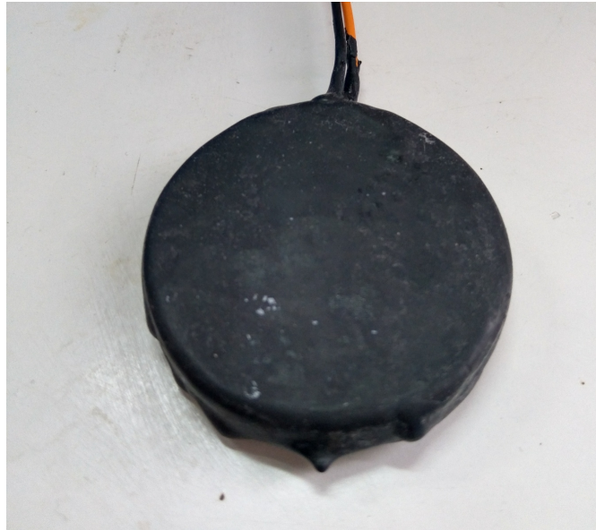
Σχήμα 6.3.2.6: Η στεγανοποιημένη κατασκευή μετά τη δοκιμή της αδιαβροχοποίησης.
