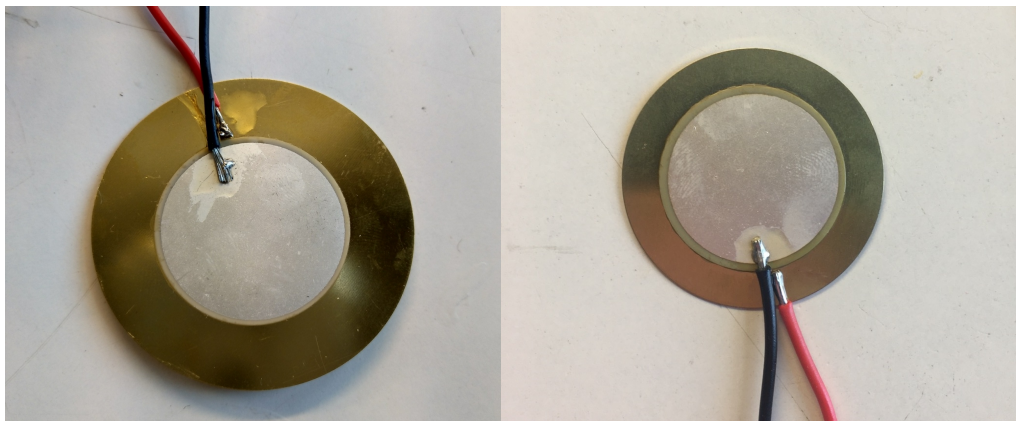
Σχήμα 6.1.3: Συγκόλληση καλωδίων στα ηλεκτρόδια της πιεζοηλεκτρικής κάψας πριν το στάδιο της αδιαβροχοποίησης.
