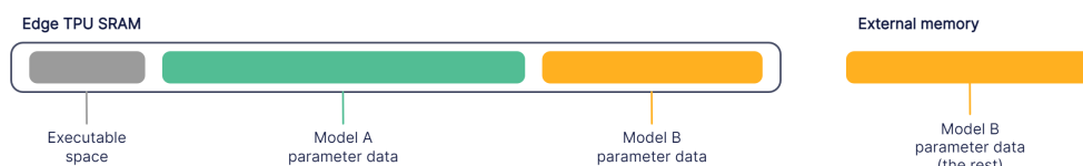
Figure 2.7: Edge TPU RAM parameter data fitting
