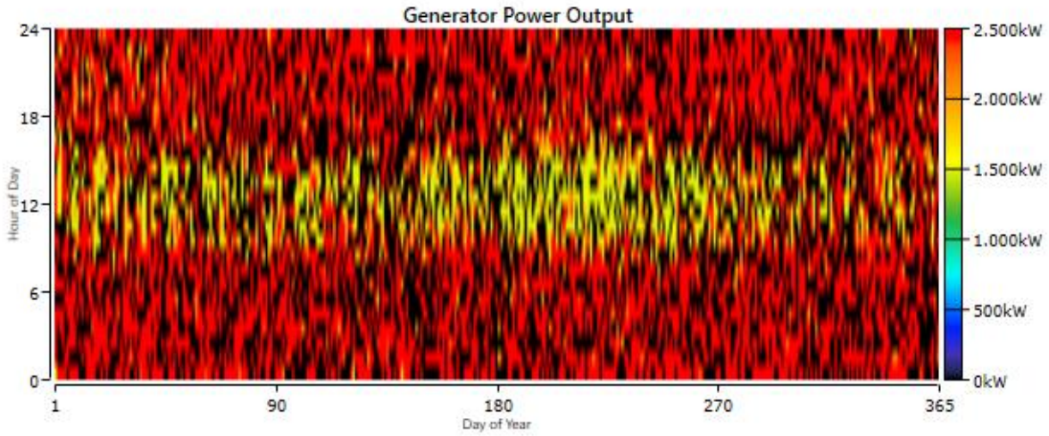
Σχήμα 94: Ισχύς Εξόδου της δεύτερης εκ των δύο Συμβατικών Γεννητριών GMT - FIAT C4212ESS (2.500 kW), Σεναρίου 2.
