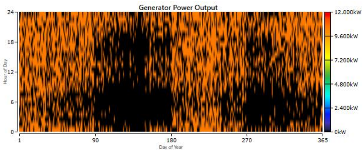
Σχήμα 72: Ισχύς Εξόδου της Συμβατικής Γεννήτριας CEGIELSKI 9RTAF58 (11.000 kW) , Σεναρίου 1.
