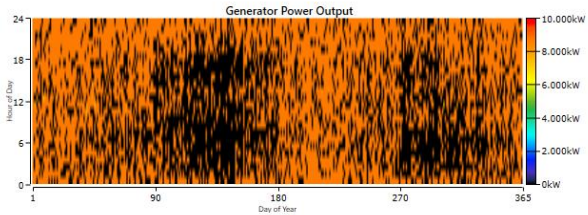
Σχήμα 107: Ισχύς Εξόδου της Συμβατικής Γεννήτριας CEGIELSKI 9RTAF58 (9.000 kW),Σεναρίου 3.
