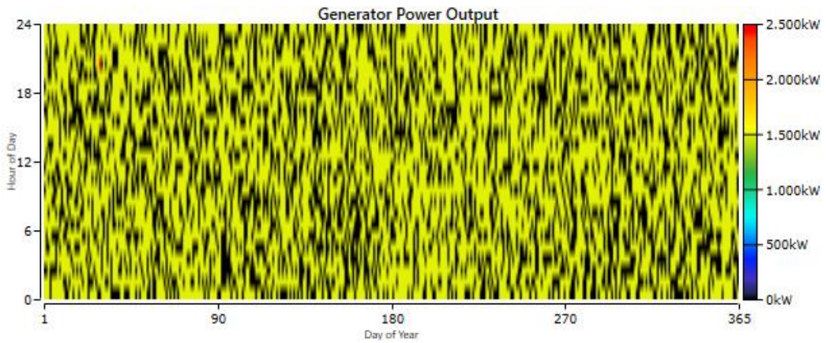
Σχήμα 78: Ισχύς Εξόδου της δεύτερης εκ των δύο Συμβατικών Γεννητριών GMT - FIAT C4212ESS (2.500 kW), Σεναρίου 1.
