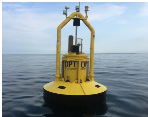
Σχήμα 43: Συσκευή σημαδούρας για αξιοποίηση κυμάτων της εταιρείας OPT. Πηγή: https://oceanpowertechnologies.com/
