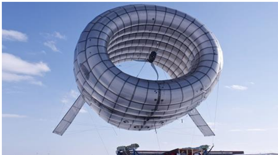
Σχήμα 32: Αερομεταφερόμενη ανεμογεννήτρια της Altaeros Energies. Πηγή: https://scitechdaily.com/high-altitude-blimp-wind-turbine-will-harness-stronger-winds/
