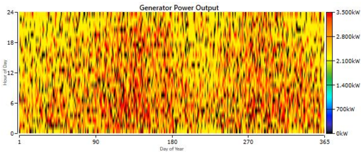
Σχήμα 75: Ισχύς Εξόδου της δεύτερης εκ των τριών Συμβατικών Γεννητριών GMT A420.12 (3.500 kW) , Σεναρίου 1.
