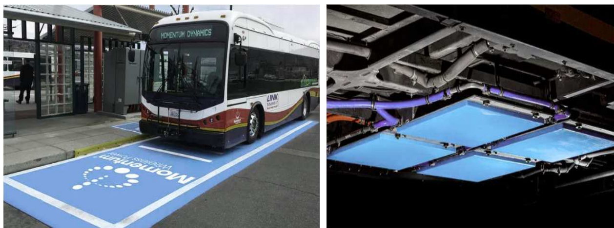
Εικόνα 12. Ασύρματη φόρτιση σε ηλεκτρικό λεωφορείο στην στάση επιβατών και στην διπλανή εικόνα τα μαξιλάρια επαγωγικής φόρτισης στο κάτω μέρος του λεωφορείου https://spectrum.ieee.org/wireless-charging-tech-to-keep-evs-on-the-go
