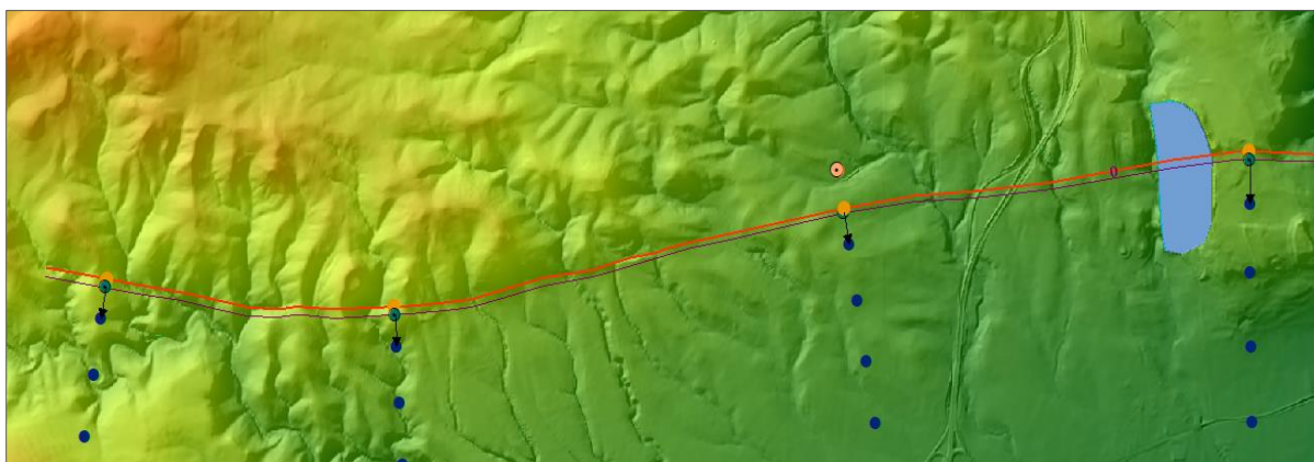
Εικ. 35 Μεταφορά της γεωμετρίας του ίχνους στις ισαριθμικές καμπύλες και παράδειγμα σημείων ελέγχου. Σε αρκετές περιπτώσεις, γίνεται χειροκίνητη γενίκευση όσο προχωράμε σε βάθος.
