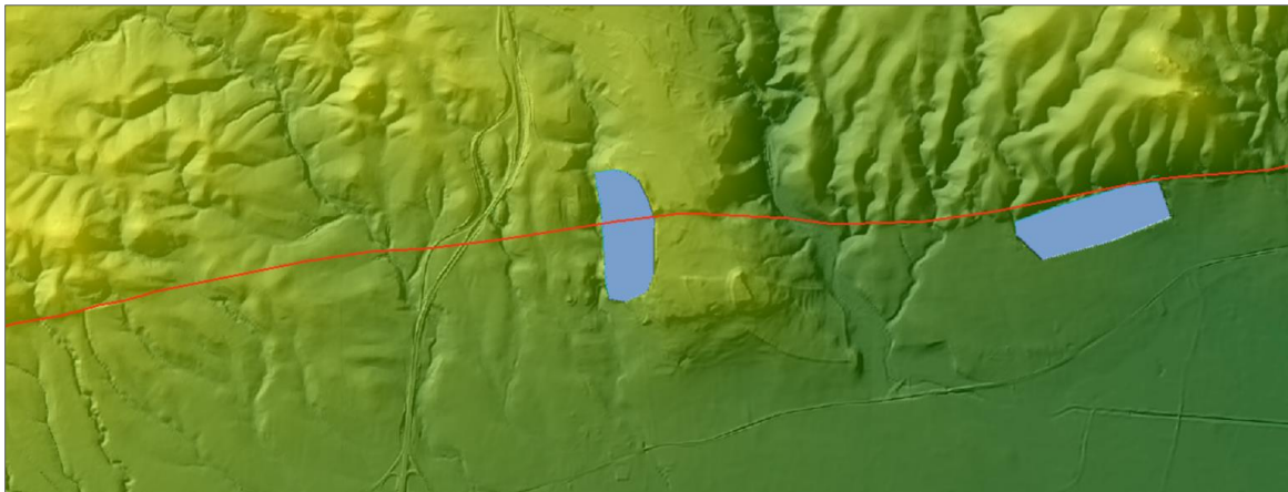
Εικ. 23 Τμήμα του ψηφιοποιημένου ίχνος του ρήγματος στο ανάγλυφο του ΨΜΕ
