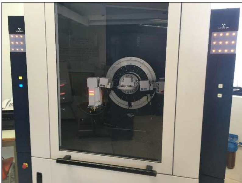
Εικόνα 3.4: Το περιθλασίμετρο (X-ray diffraction) D8 Advance της Bruker.
