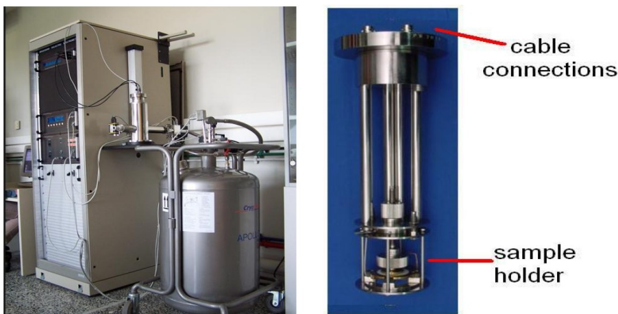
Εικόνα 2.7- Πειραματική Διάταξη DRS Novocontrol (αριστερά) και κυψελίδα τοποθέτησης δοκίμιο (δεξιά) [93]
