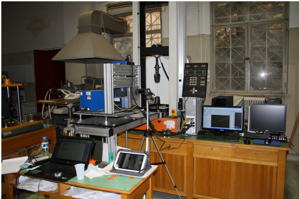
Εικόνα 2.18 - Πειραματική διάταξη Instron 1121 και Fielder Optoelektronik K-100
