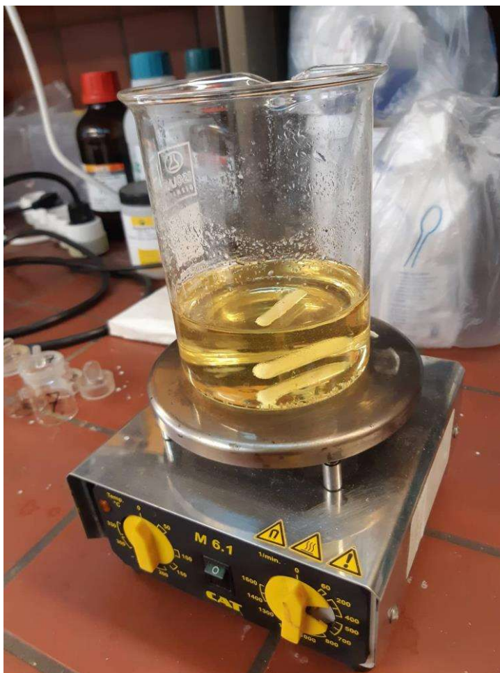
Εικόνα 13. Τελικό στάδιο της παρασκευής του ευτηκτικού διαλύτη
