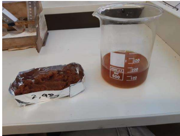
Εικόνα 8. Διαχωρισμός στερεού υπολείμματος και πρωτεϊνικού εκχυλίσματος
