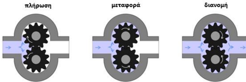
Σχήμα 19: Τομή και λειτουργία γραναζωτής αντλίας [27].
