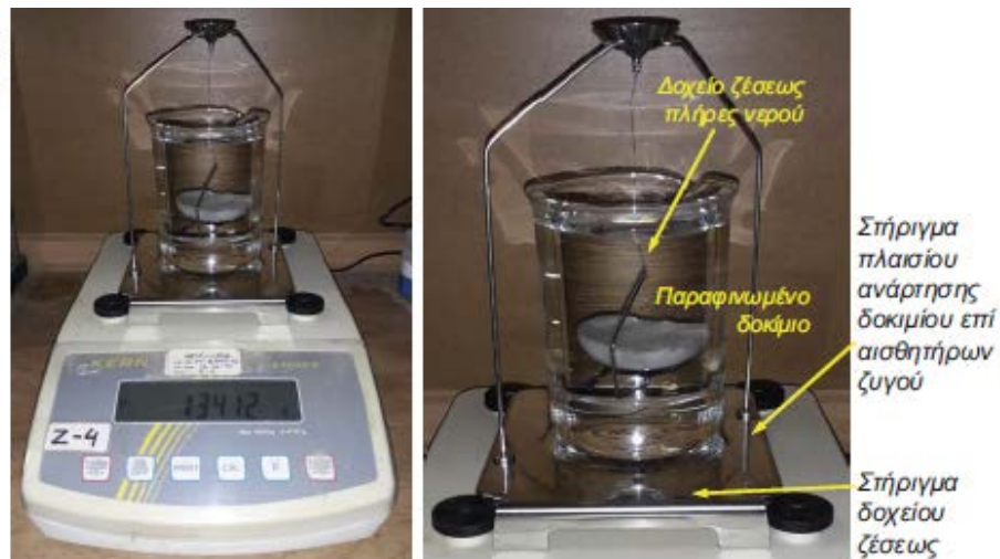
Σχήμα 3.4.3 Εργαστηριακή διάταξη ζύγισης των παραφινωμένων δοκιμών.
