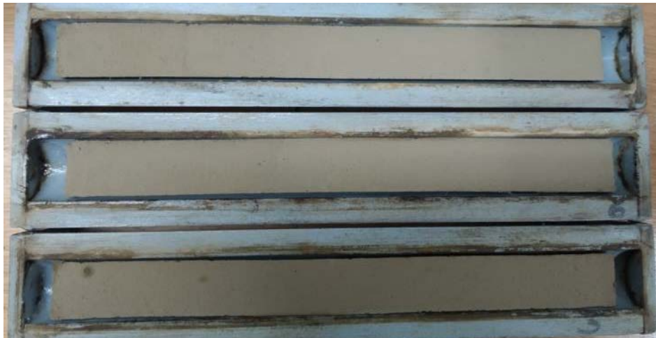
Φωτογραφία 3.2.1 Φόρμες γραμμικής συρρίκνωσης μετά από ξήρανση στην ατμόσφαιρα.
