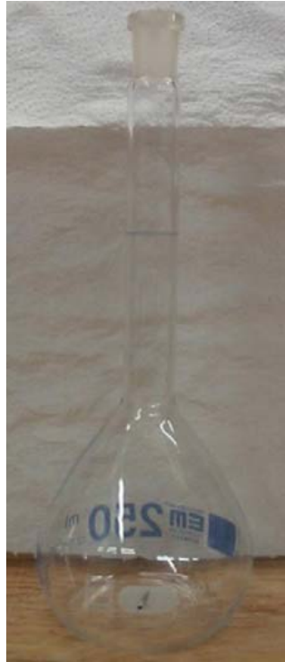
Σχήμα 3.2.11 Ογκομετρική φιάλη 250ml για τη μέτρηση του ειδικού βάρους της στερεάς φάσης (Μπαρδάνης, 2019).
