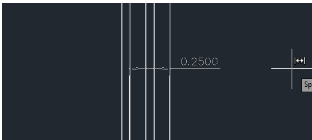
Εικόνα 20: Πάχος Εξωτερικής Τοιχοποιίας
