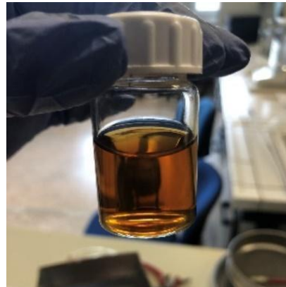
Εικόνα 4.28 Διάλυμα CDs μετά από φυγοκέντρηση και διήθηση.
