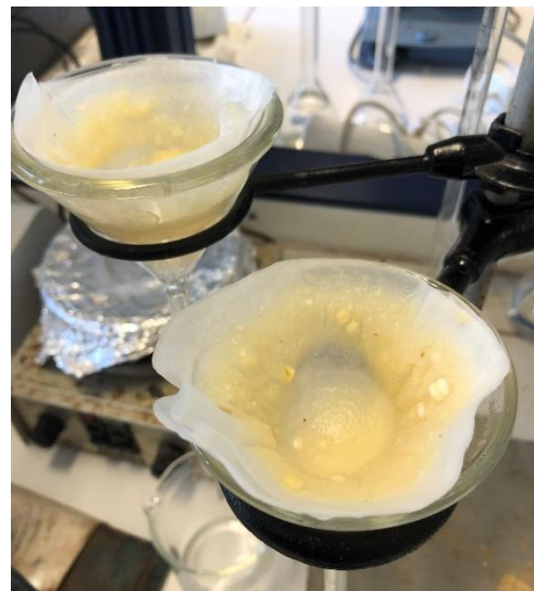
Εικόνα 4.24 Διήθηση διαλύματος μετά την όξινη κατεργασία και συνεχείς εκπλύσεις έως ουδέτερο pH.
