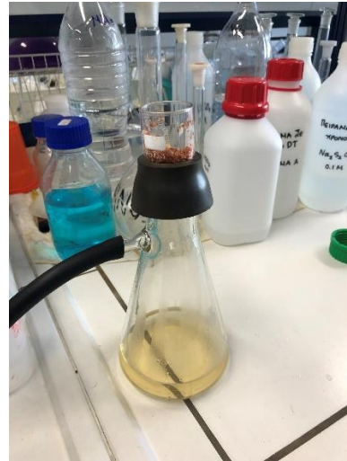
Εικόνα 4.4 Διήθηση υπό κενό για την απομάκρυνση των υδατοδιαλυτών.
