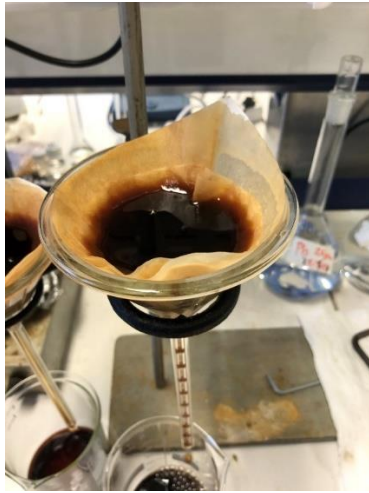
Εικόνα 4.21 Διήθηση και εκπλύσεις ιζήματος έως ουδέτερο pH για την διαλυτοποίηση των ημικυτταρινών σε υδατικό αλκαλικό διάλυμα (NaOH).
