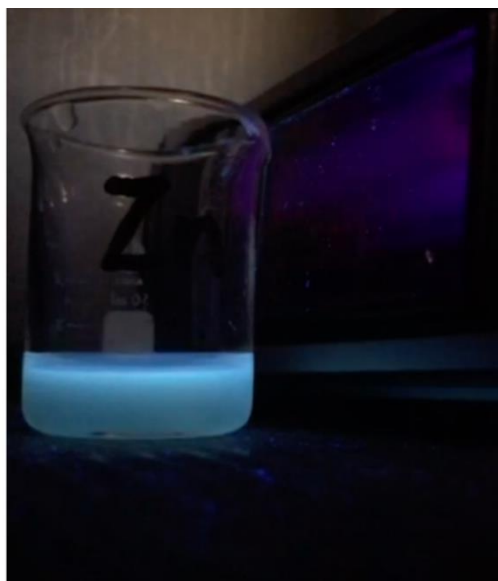
Εικόνα 5.6 Διέγερση CDs υπό υπεριώδη ακτινοβολία (λάμπα UV στα 365 nm).
