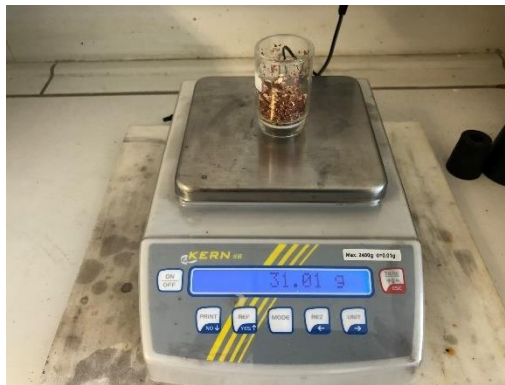
Εικόνα 4.5 Δείγμα ακατέργαστου σπάδικα καλαμποκιού, μετά την ξήρανση για μέτρηση υδατοδιαλυτών στερεών.
