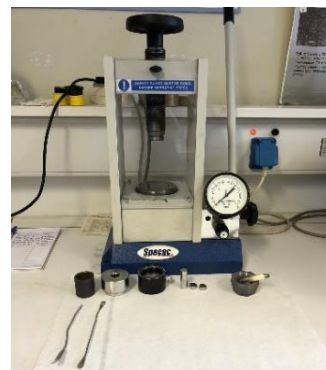
Εικόνα 5.3 Χειροκίνητη υδραυλική πρέσα Specac Atlas 15T και μήτρα για προετοιμασία παστίλιας.
