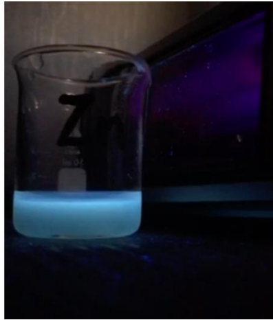
Εικόνα 4.32 Διέγερση N,S co – doped CDs υπό υπεριώδη ακτινοβολία (λάμπα UV στα 365 nm).
