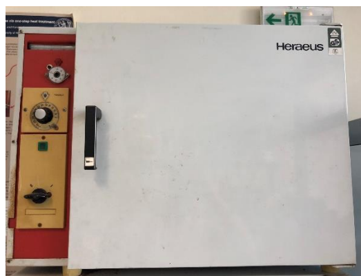
Εικόνα 4.2 Πυριατήριο με ρεύμα αέρα στους 105 °C.
