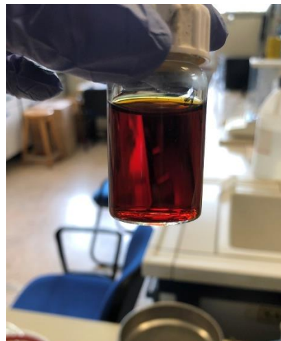
Εικόνα 4.31 Διάλυμα N,S co – doped CDs μετά από φυγοκέντρηση και διήθηση.
