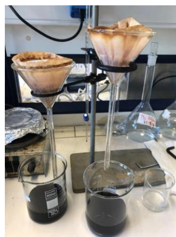
Εικόνα 4.20 Διήθηση μίγματος για την διαλυτοποίηση των ημικυτταρινών σε υδατικό αλκαλικό διάλυμα (NaOH)
