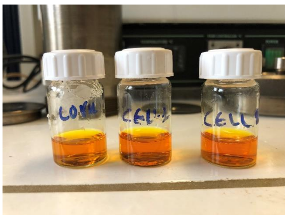
Εικόνα 4.15 Ανάμιξη δειγμάτων με DNS.
