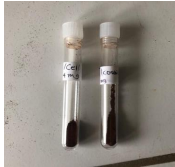
Εικόνα Παραρτήματος 4 \text{Fe}_3\text{O}_4 / N, S co-doped CDs Corn και \text{Fe}_3\text{O}_4 / N, S co-doped CDs Cellulose σε μορφή σκόνης.
