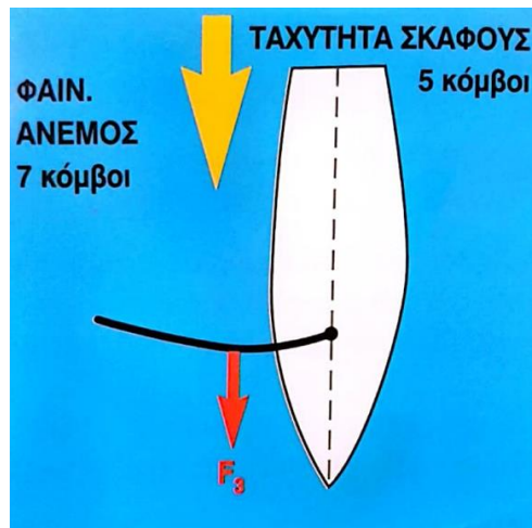
Εικόνα 1.25: Συνισταμένη αεροδυναμική δύναμη στα κατάπρυμα
