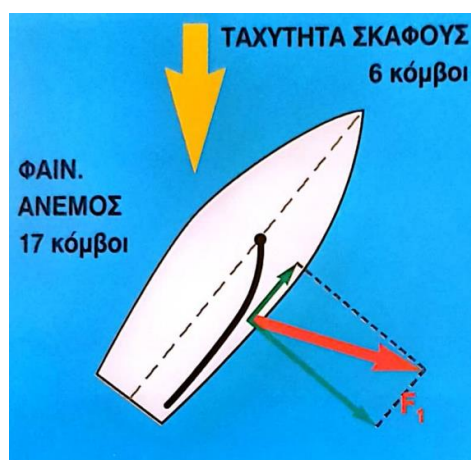
Εικόνα 1.23: Συνισταμένη αεροδυναμική δύναμη στα όρτσα
