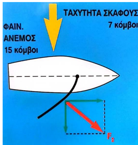
Εικόνα 1.24: Συνισταμένη αεροδυναμική δύναμη στην πλαγιοδρομία (Πηγή: Στρούζας, 2003)
