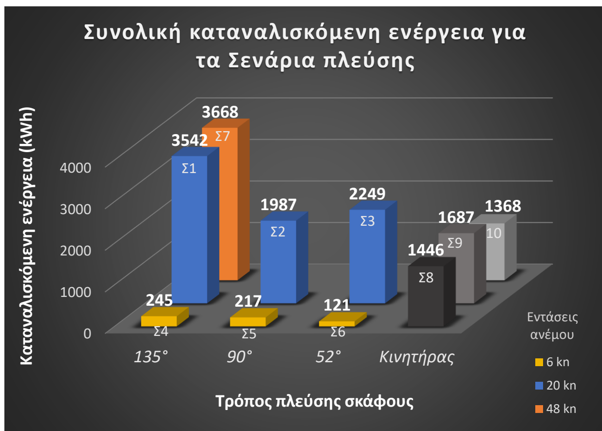
Διάγραμμα 4.5: Καταναλισκόμενη ενέργεια για το σύνολο της διαδρομής για τα Σενάρια πλεύσης
