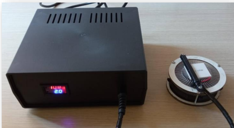
Εικόνα 30: Πρώτη κατασκευή με τον ψηφιακό θερμοστάτη-ρυθμιστή
