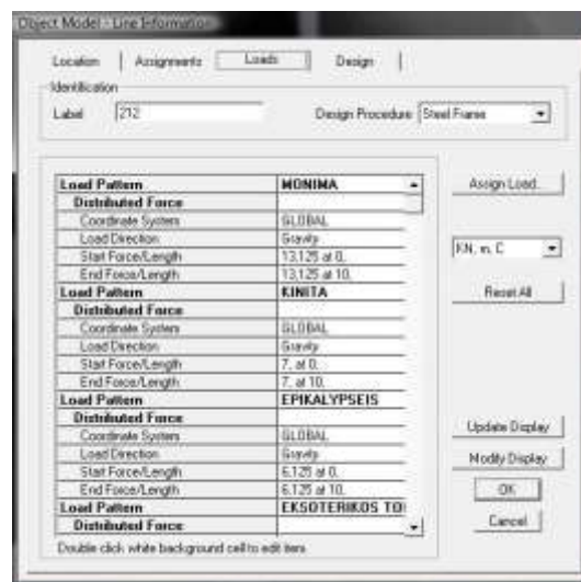
Εικόνα16. Ομοιόμορφα κατανεμημένα φορτία δοκού
