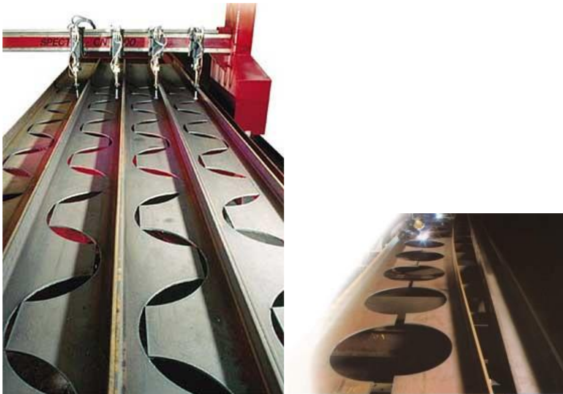
Σχήμα 1.16 Στάδια κατασκευής δοκών με κυκλικές οπές
