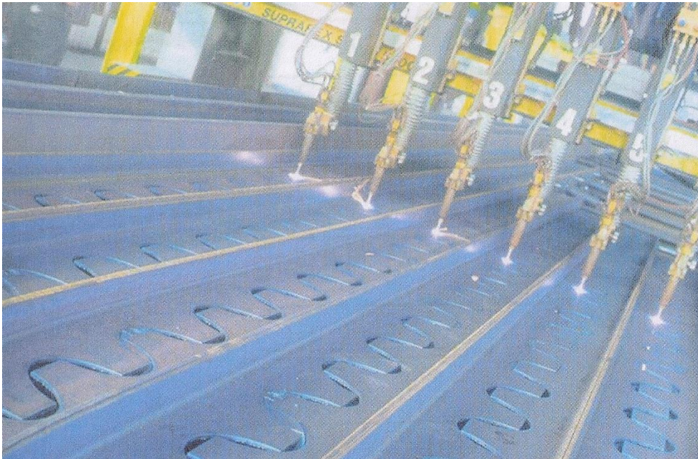
Σχήμα 1.15 Κοπή πρότυπων διατομών διπλού ταυ για την κατασκευή δοκών με κυκλικές οπές
