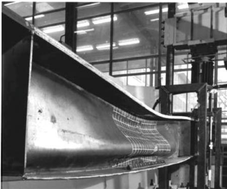
Σχήμα 2.20 Διατμητικός λυγισμός κορμού
