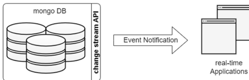
Σχήμα 6.4: Σχεδιάγραμμα της λειτουργίας «Change Streams» της MongoDB
