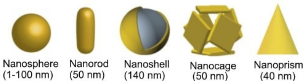
Εικόνα 4.1 : Απεικόνιση διαφόρων σχημάτων νανοδομημάτων χρυσού. Στην παρούσα διπλωματική εργασία χρησιμοποιήθηκαν οι νανοσφαίρες και τα νανοκελύφη.
