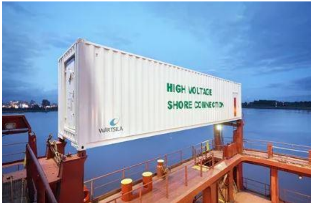
Εικόνα 20: Εγκατάσταση συστήματος cold ironing στο πλοίο (wartsila)
