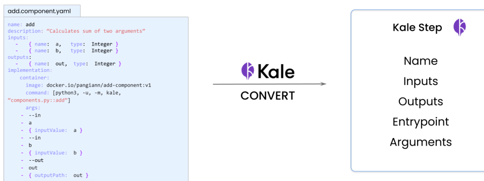
Σχήμα 4.6: Η μετατροπή ενός YAML αρχείου σε ένα Kale step
