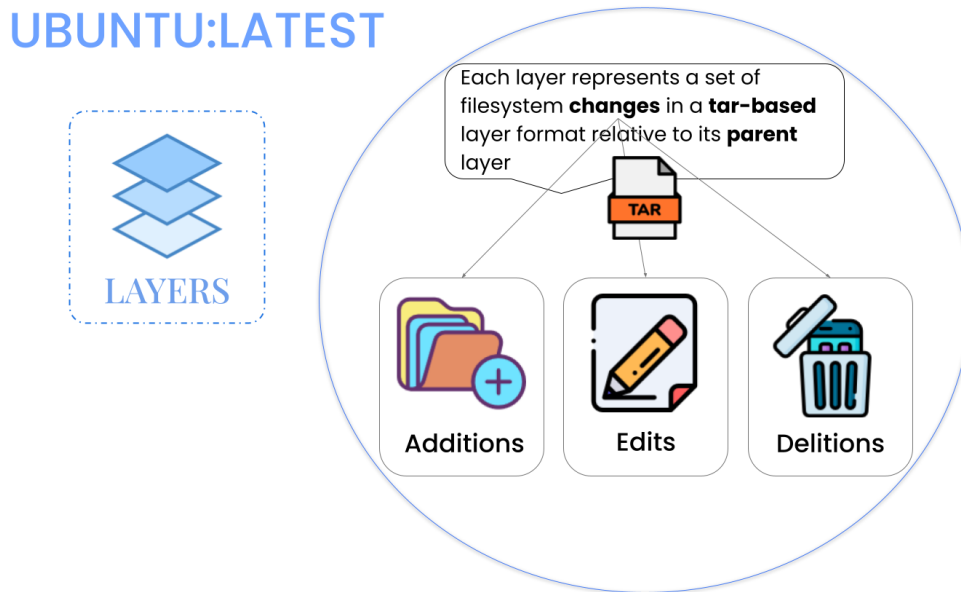
Σχήμα 3.3: Η ανατομία μίας εικόνας περιεκτών: επίπεδο εικόνας
