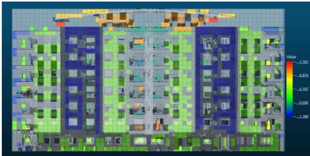
Εικόνα 3.18, Η κάθετη προβολή των σημείων στο επίπεδο και ο μετασχηματισμός του στο οριζόντιο επίπεδο.
