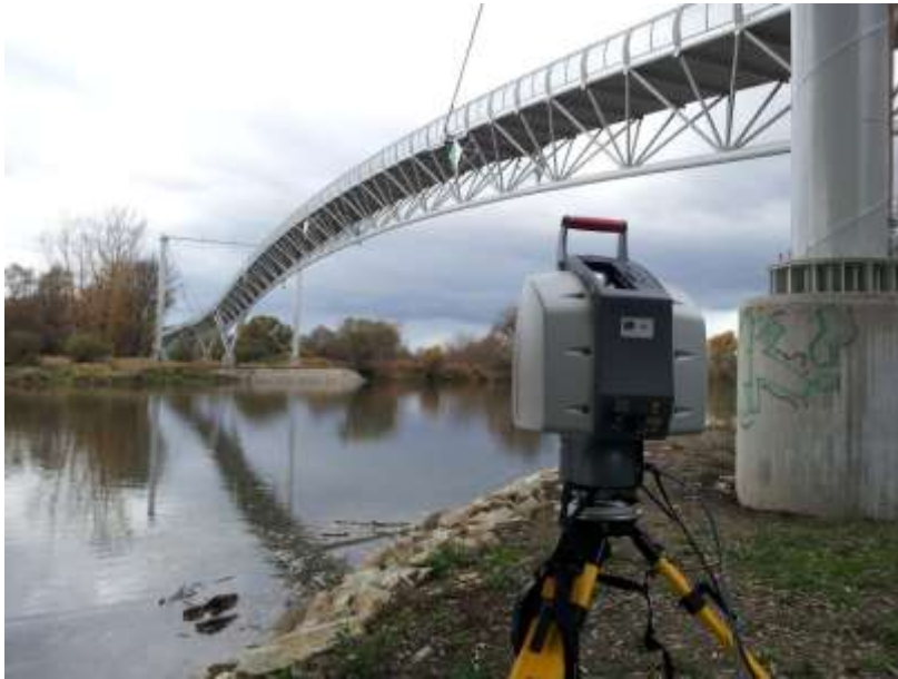
Εικόνα 1.1, Παρακολούθηση μικρομετακινήσεων γέφυρας με χρήση επίγειου σαρωτή στην Μπρατισλάβα, Σλοβακία.
