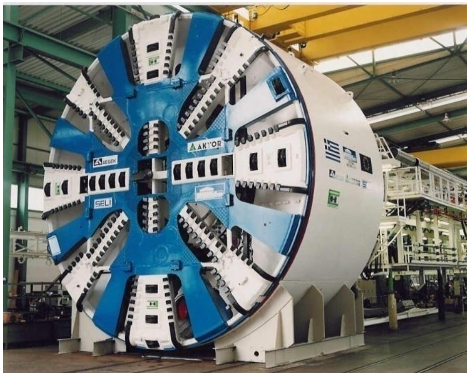
Εικόνα 3.2.12 Μηχανή «TBM- S5» της Herrenknecht ( www.ametro.gr )
