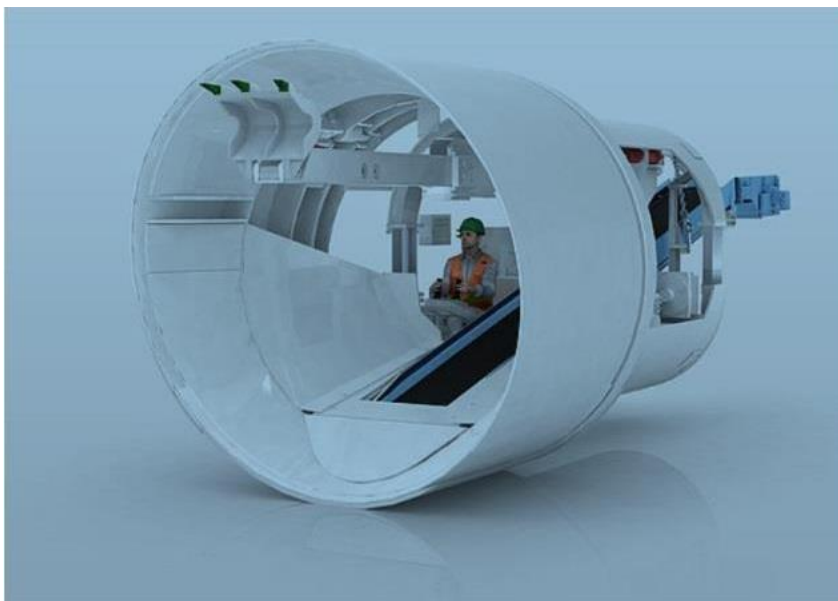
Εικόνα 3.2.1 Μηχανή μερικής κοπής με ασπίδα SM-T1 της Herrenknecht (Σοφιανός Α., 2018)
