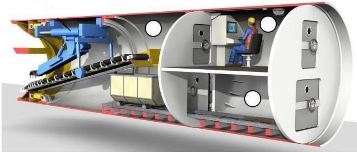
Εικόνα 3.2.5 Ασπίδα στήριξης μετώπου με πεπιεσμένο αέρα «SM-T3» - Herrenknecht (Σοφιανός Α., 2018)
