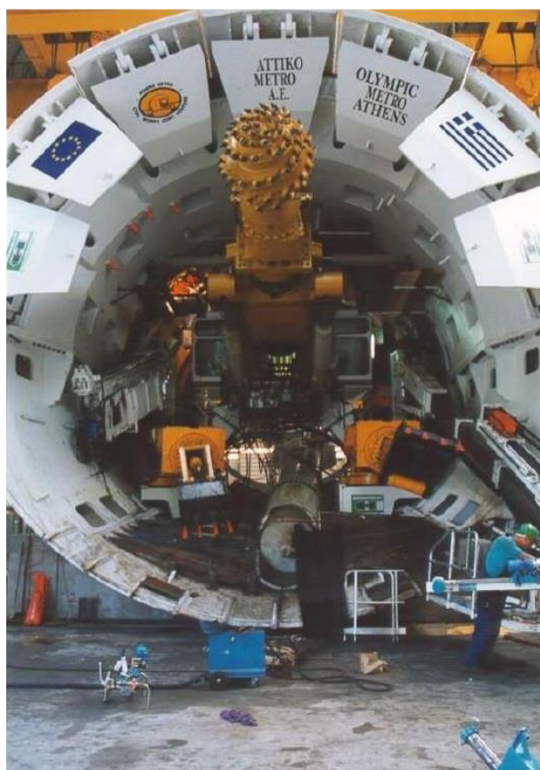
Εικόνα 3.2.3 Μηχανή μερικής κοπής τύπου SM-T2 τύπου OFS της Herrenknecht ( www.ametro.gr )
