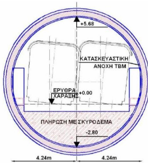
Εικόνα 2.1.3 Τυπική διατομή σήραγγας ΤΒΜ διπλής τροχιάς του μετρό Αθήνας. (Μπούσουλας Ν., 2012)
