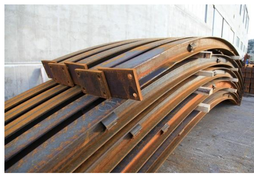
Εικόνα 4.2.5 Τύποι μεταλλικών πλαισίων: (1) Εύκαμπτα (2) Άκαμπτα (Εικόνα από το διαδίκτυο)
