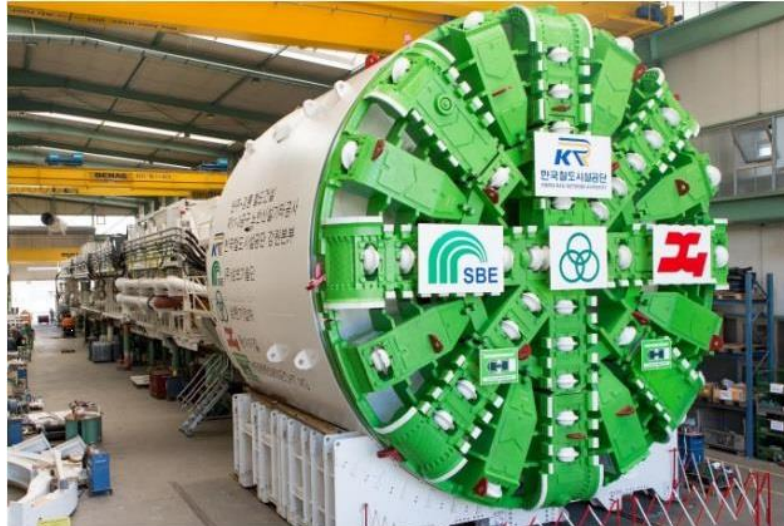
Εικόνα 3.5.14 Η μηχανή τύπου Slurry της Herrenknecht . (Duhme R., 2017)
