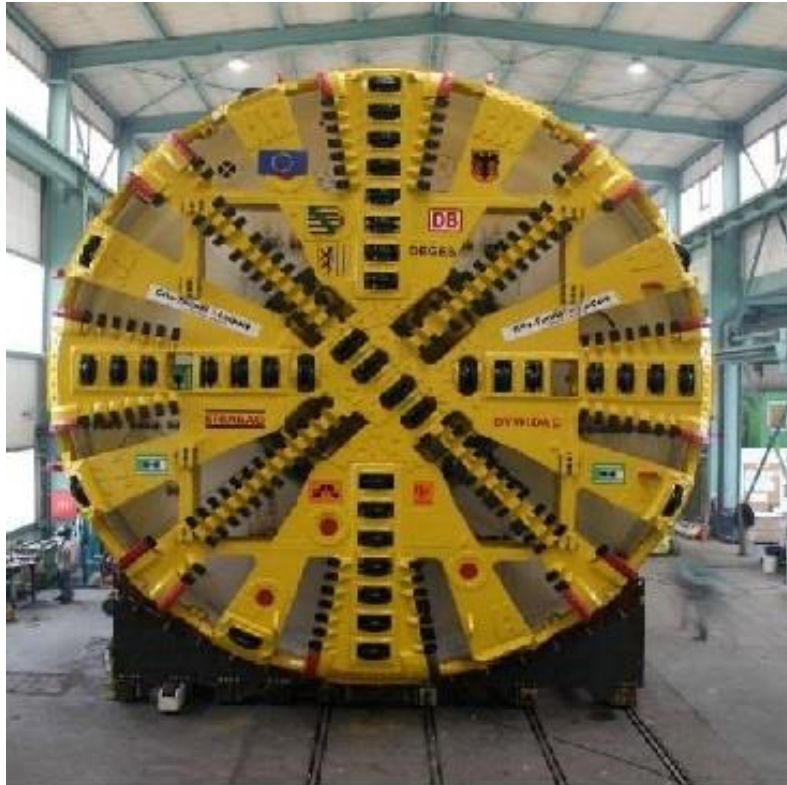
Εικόνα 3.2.8 Μηχανή ολομέτωπης κοπής «SM-V4»- Herrenknecht (Κουκουτάς Σ., 2015)
