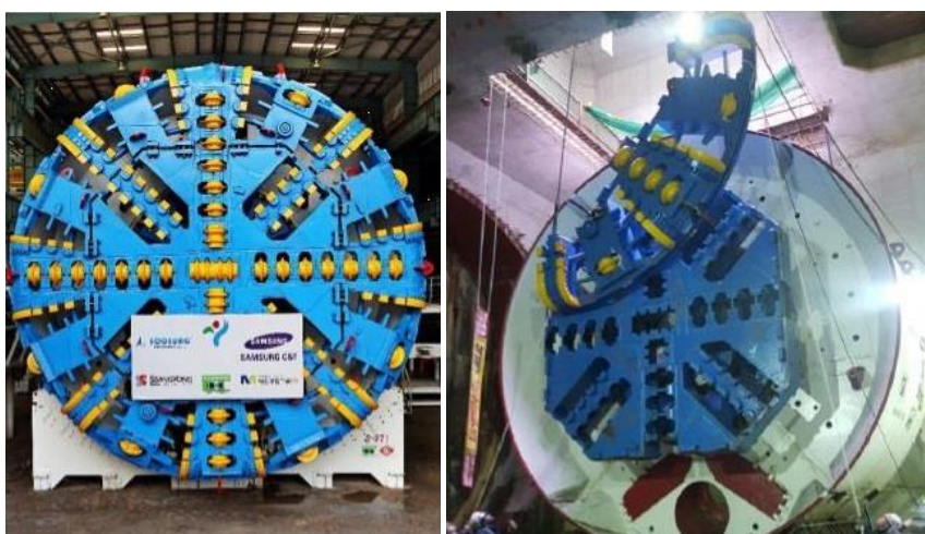
Εικόνα 3.5.12 Η μηχανή EPB της Herrenknecht. (Duhme R., 2017)
