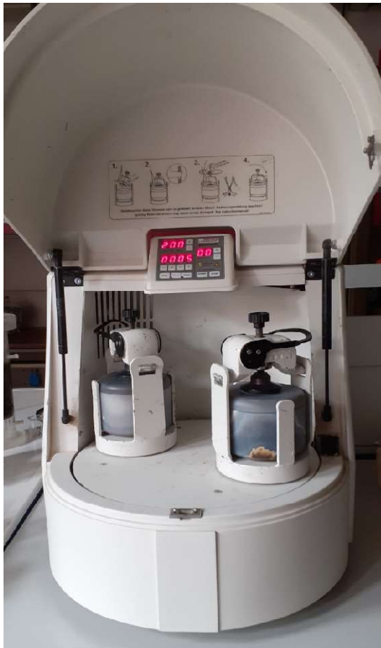
Εικόνα 10 Επεξεργασία εδαφικών δειγμάτων στο εργαστήριο Γεωλογίας του Τομέα Γεωλογικών Επιστημών της Σχολής Μηχ. Μεταλλείων-Μεταλλουργών. Διαδικασία κονιοποίησης.
