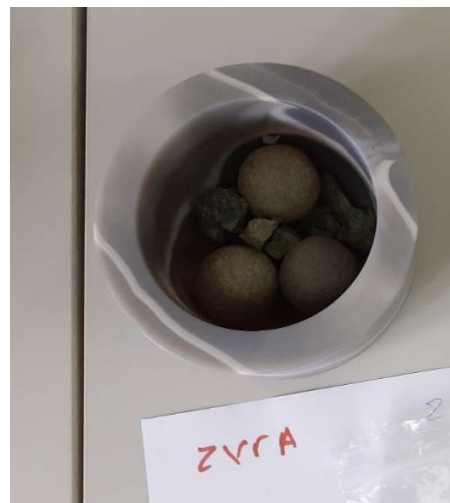
Εικόνα 10 Επεξεργασία εδαφικών δειγμάτων στο εργαστήριο Γεωλογίας του Τομέα Γεωλογικών Επιστημών της Σχολής Μηχ. Μεταλλείων-Μεταλλουργών. Διαδικασία κονιοποίησης.
