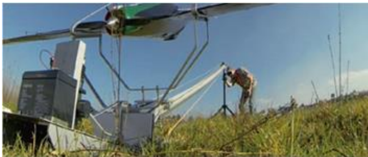
Σχήμα 7. 8: Το πρωτότυπο drone Delta σταθερής πτέρυγας με άνοιγμα φτερών 2 μέτρα, για μεταφορά ιατροφαρμακευτικών προμηθειών σε αγροτικές περιοχές (χρόνος πτήσης: 45΄ ταχύτητα πτήσης 70km/h) (Wulfovich et al., 2018)
