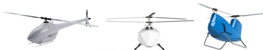
Σχήμα 3. 8: Ελικόπτερο μονής έλικας, ελικόπτερο ομοαξονικής έλικας, ελικόπτερο παράλληλης έλικας (Prodrone, 2017)
