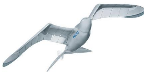
Σχήμα 3. 10: Drone διαμόρφωσης ορνιθοπτέρου (Festo, 2011)
