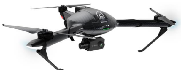
Σχήμα 3. 14: Drone διαμόρφωσης τρικοπτέρου (Pierce, 2016)
