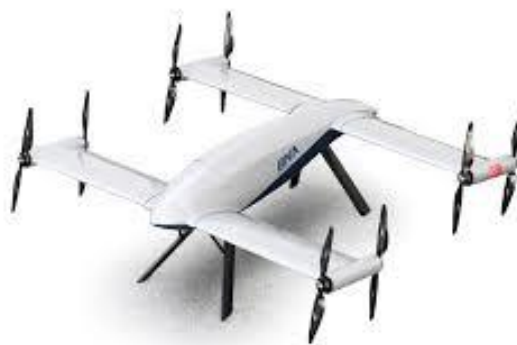
Σχήμα 3. 3: Drone κατηγορίας κλίνοντος στροφείου (Defence Turkey, 2020)
