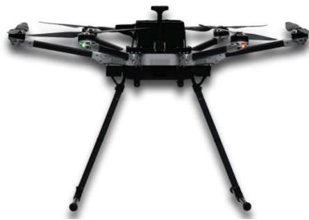
Σχήμα 3. 16: Drone διαμόρφωσης εξακοπτερου (Frontier Precision, 2022)
