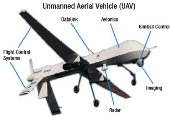
Σχήμα 2. 4: Σύνθεση υποσυστημάτων drone από Electronic Products
