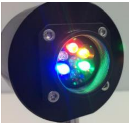
Εικόνα 12 7 Led (405nm, 465nm, 525nm, 639nm, 870nm, 940nm και 1050nm) (Cohen, 2018)
