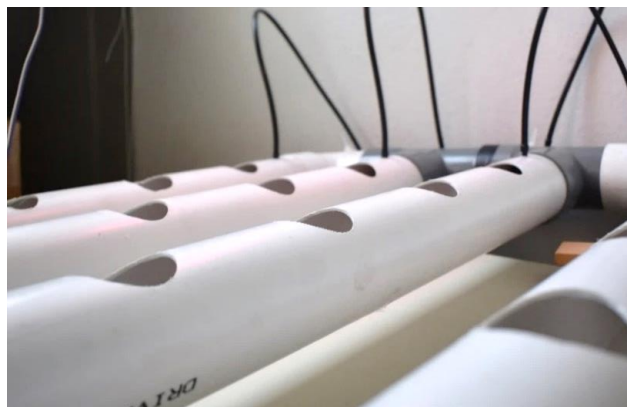
Σχήμα 71: Σωλήνες του συστήματος υδροπονίας.
