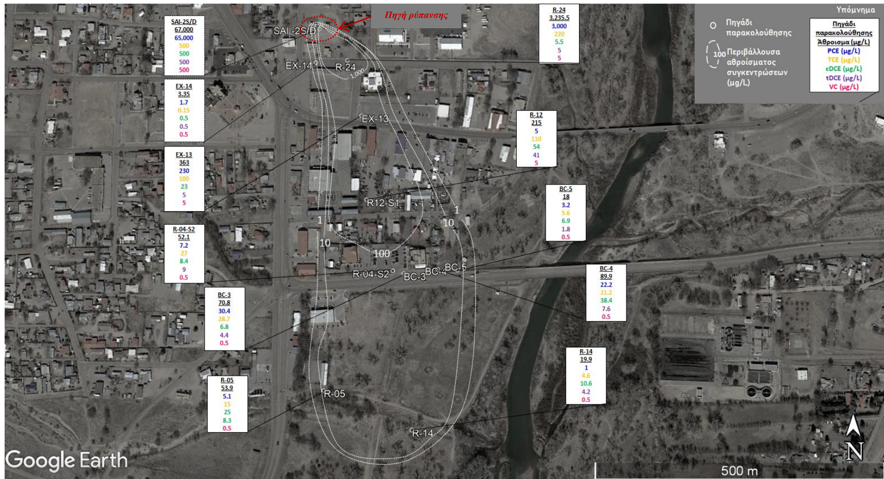
Σχήμα Α.4.6 Ρυπασμένη περιοχή με χλωροαιθένια στη ρηχή στρώση στην πόλη Εσπανιόλα το 2007 (χάρτης από δορυφόρο-Google Earth Pro)
